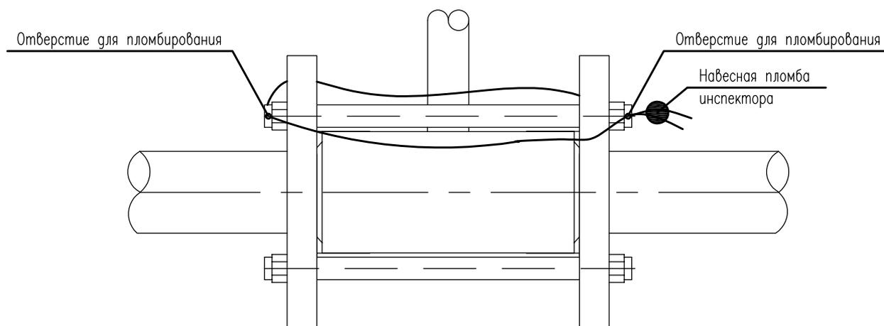
Схема пломбирования термпреобразователя ТЭМ
