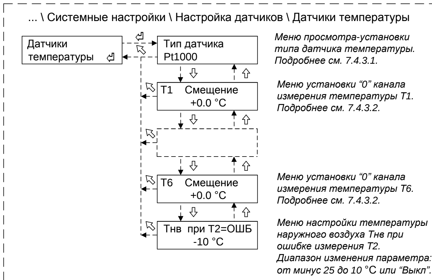
Рисунок 9 – Структура меню настройки датчиков температуры
