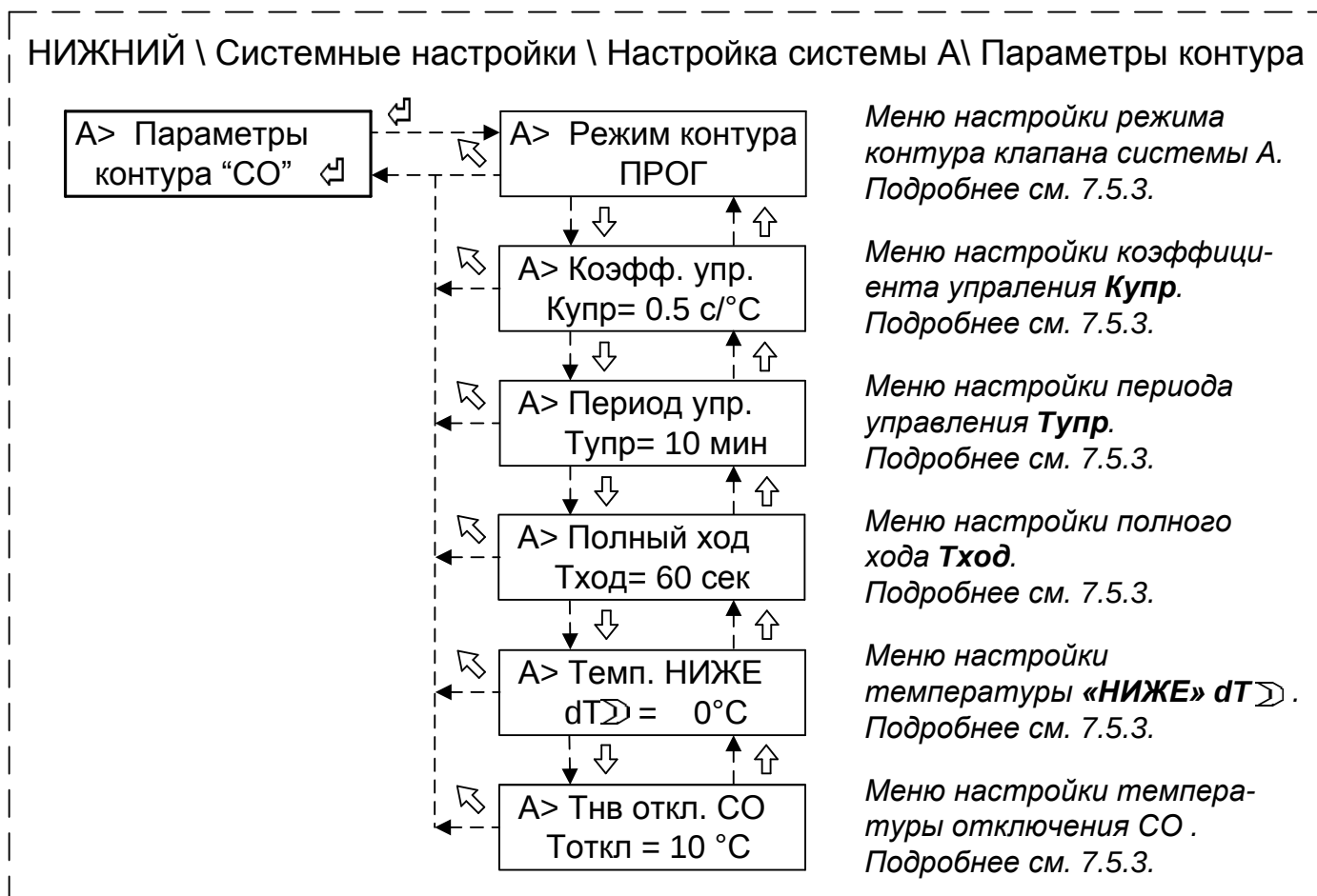
Рисунок 12 - Структура меню настройки параметров контура “СО”
