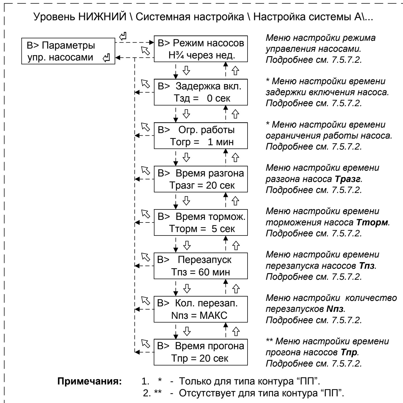
Рисунок 19 - Структура меню настройки параметров управления насосов
