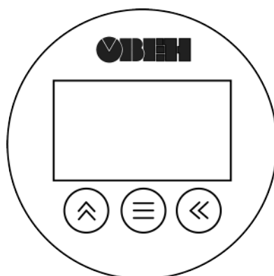
Рисунок 3.4 – Лицевая панель вычислительного блока
