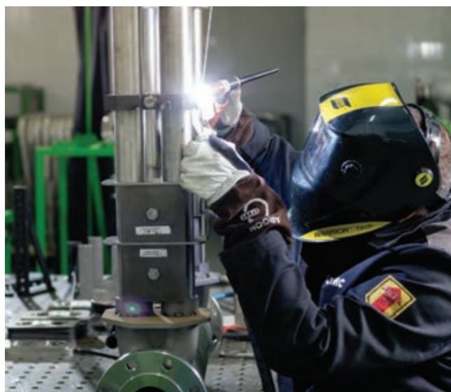
Сварка кориолисовых расходомеров ЭМИС-МАСС 260
