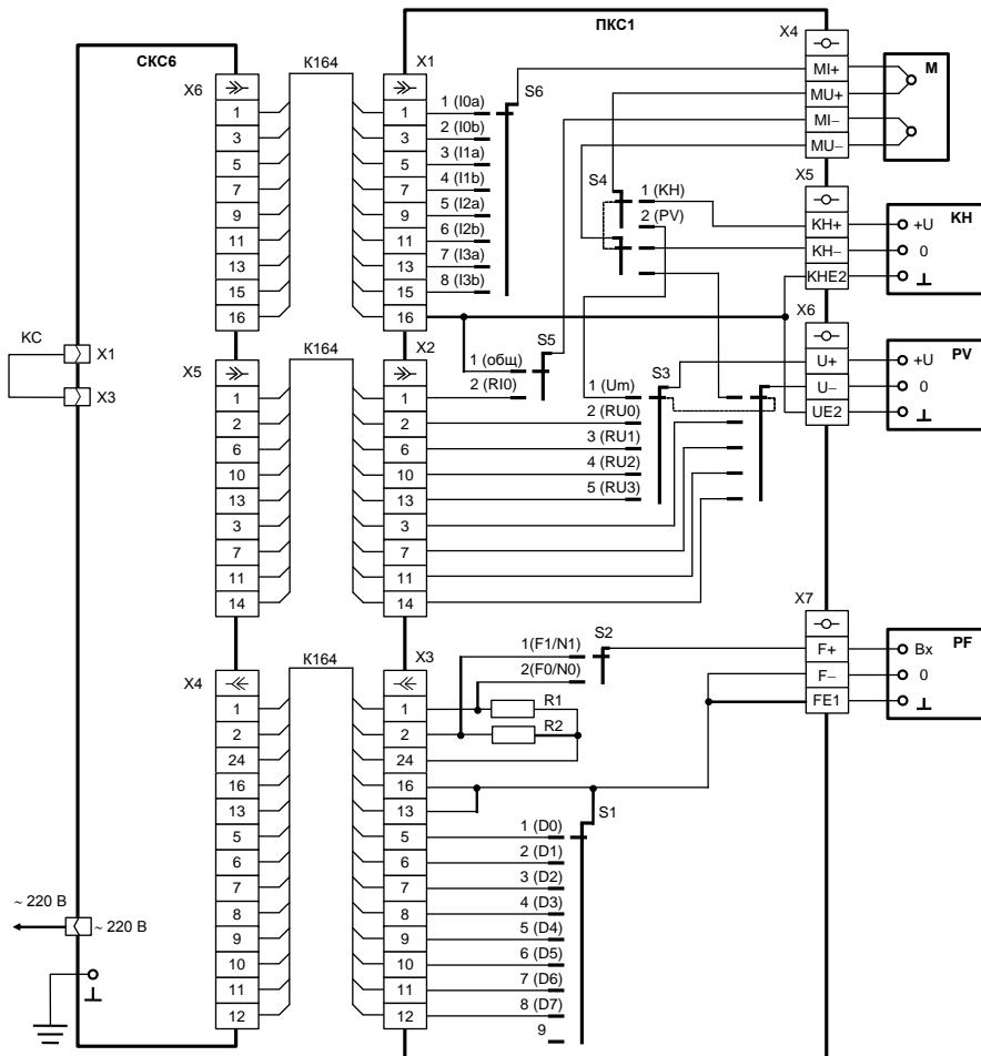
СКС6 – поверяемый стенд; KH – компаратор напряжений; M – магазин сопротивлений; PV – вольтметр постоянного тока; PF – частотометр; K164 – коннектор; КС – кабель соединительный; ПКС1 – пульт ПКС1 (X1, X2 – розетка DB25F; X3 – вилка DB25M; X4...X7 – клеммы приборные; S1...S6 – переключатели; R1, R2 – резисторы 910 Ом, ±10 %, 0,5 Вт)
