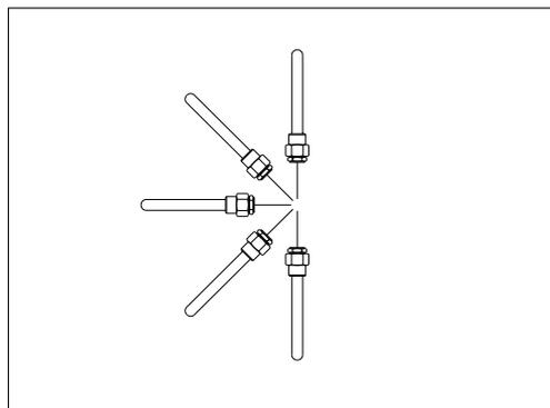
Температурный датчик L = 255 мм должен быть размещен горизонтально или опущен вниз, как показано на рисунке.
