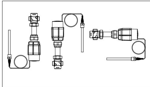
При более высоких температурах регулятор должен быть установлен в позициях, указанных на рисунке.
