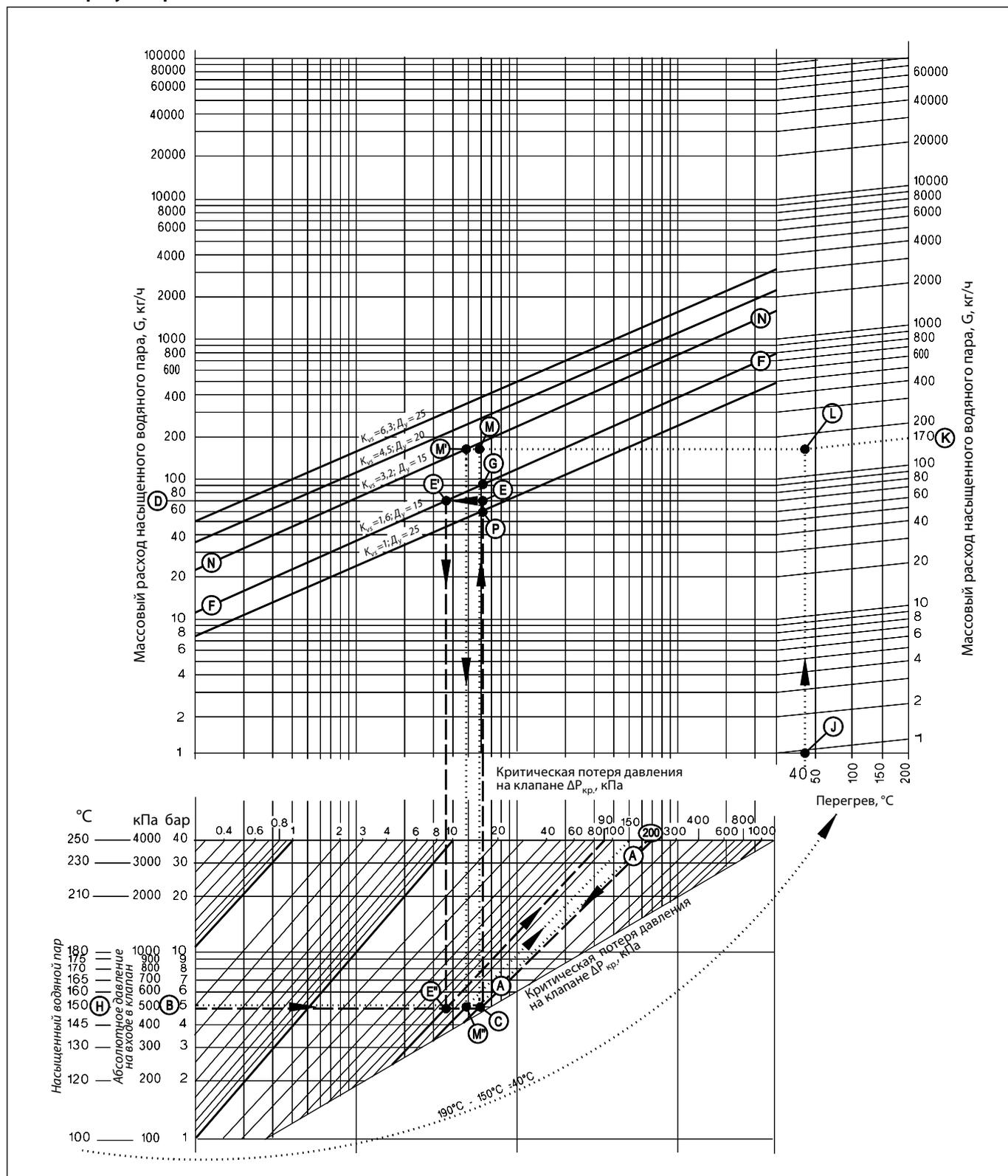
Подбор клапана-регулятора по номограмме производится при условии, что потеря давления пара в полностью открытом клапане не должна превышать 40% абсолютного давления на его входе. В таком случае пар сначала дросселируется до приближения его скорости к критическому значению (около 300 м/с), а дальнейшее дросселирование будет происходить за счет перемещения штока клапана.
