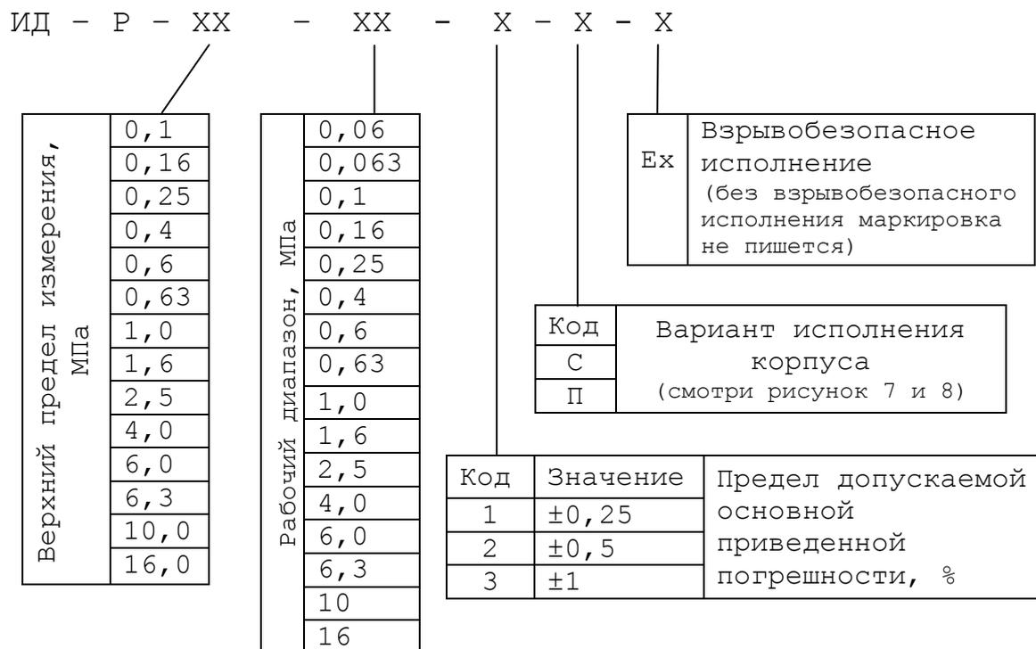
**Примечание.** При заказе датчиков разности давления необходимо учитывать, что рабочий диапазон должен быть меньше или равен верхнему пределу измерения.
