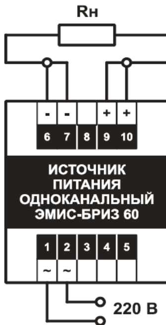
Рисунок 4.1 Схема подключения блока питания ЭМИС-БРИЗ 60 к нагрузке
