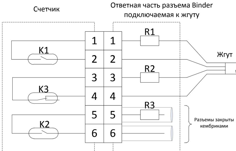
K1 и K2 рабочий и резервный рабочий герконы; K3-«сторожевой» геркон, регистрирующий несанкционированное воздействие магнитного поля на работу рабочих герконов и обрыв в электрической цепи; R1, R2, R3 – резисторы номиналом 100 Ом
