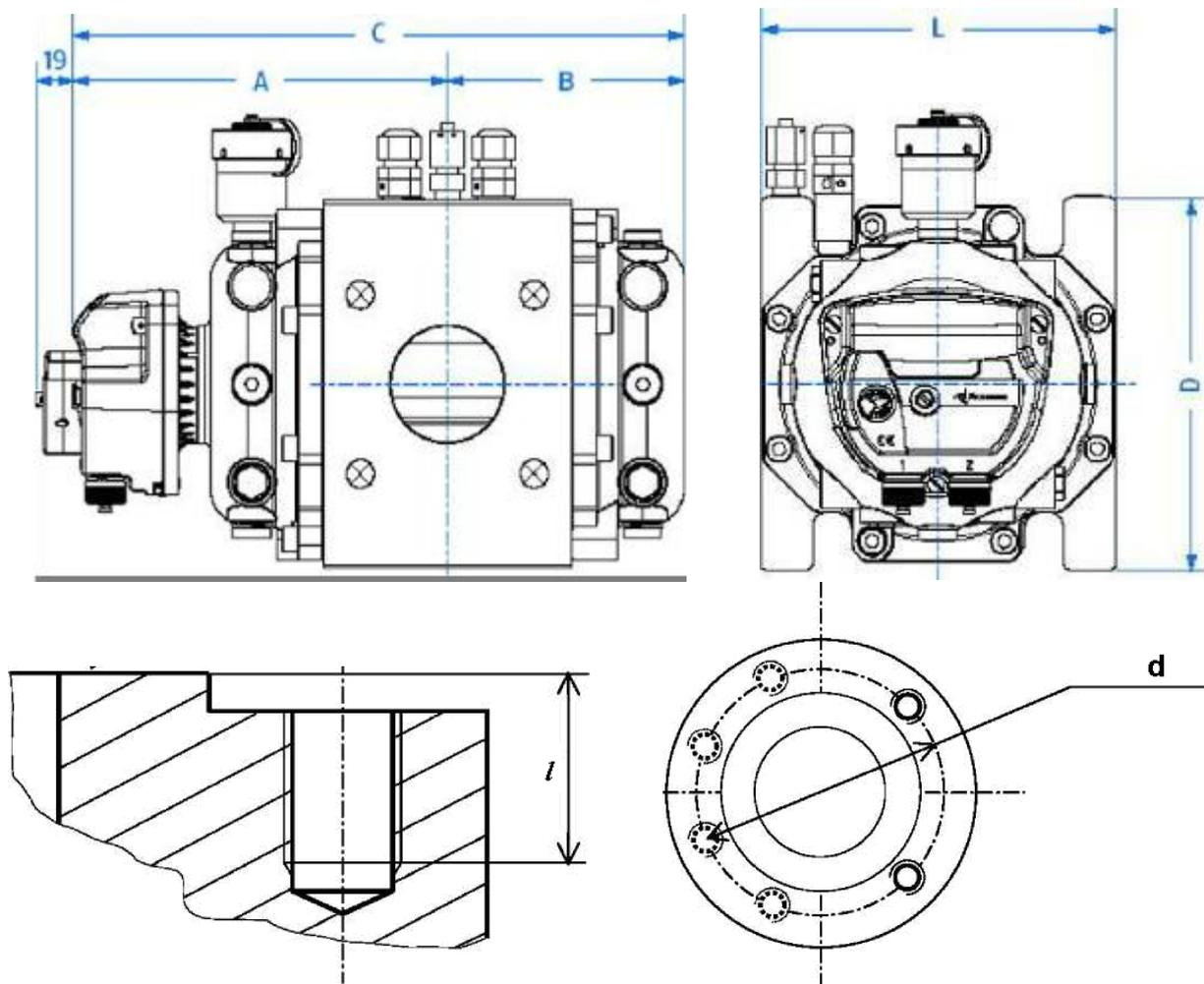
Рисунок 1 Габаритные и присоединительные размеры счетчиков РСГ СИГНАЛ
