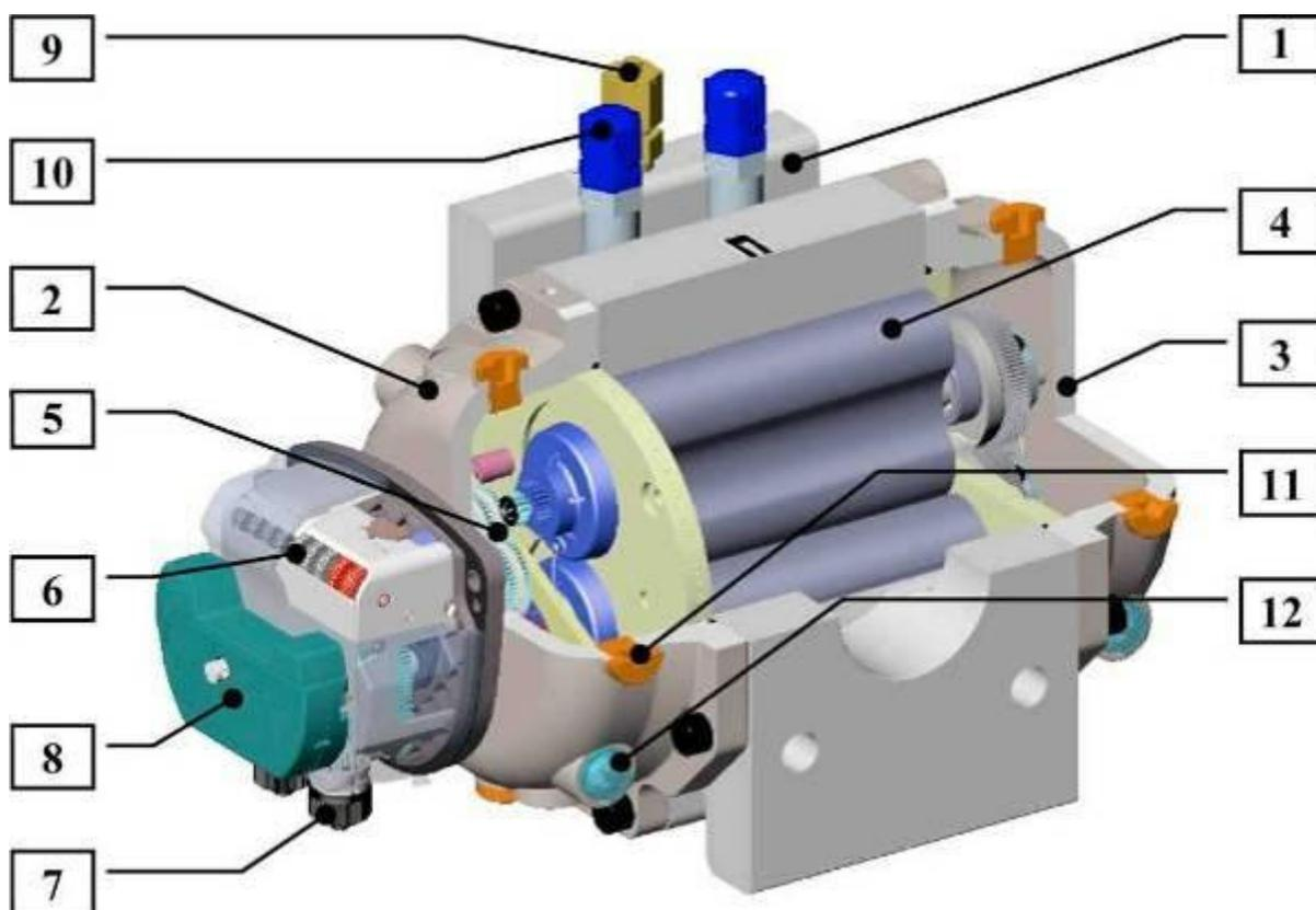
1 - Корпус; 2 - Передний картер; 3 - Задний картер; 4 - Ротор; 5 - Передаточный механизм; 6 - Роликовый сумматор; 7 - Разъем Binder; 8 - Датчик Cyble Sensor; 9 - Штуцер отбора давления; 10 - Гильза для датчика температуры; 11 - Заглушка; 12 - Индикатор контрольного уровня масла;
