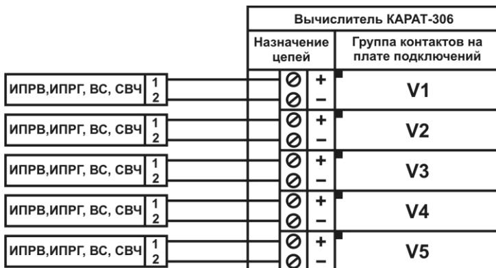
**Рисунок 2.6** – Схема подключения ИПРВ, ИПРГ, ВС и СВЧ
