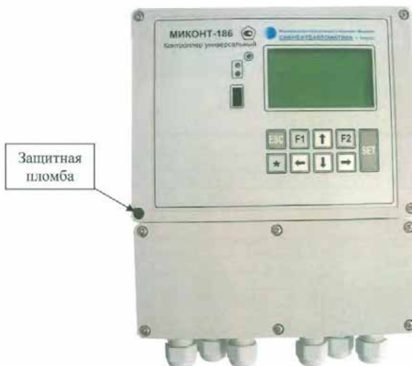
Рисунок 6 - Схема пломбировки контроллера МИКОНТ-186 от несанкционированного доступа
