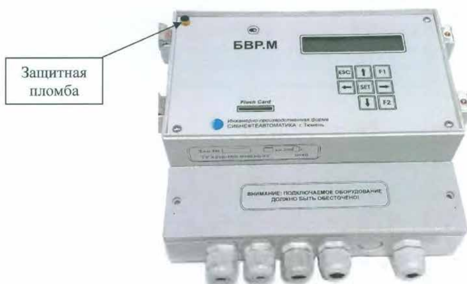
Рисунок 7 - Схема пломбировки блока БВР.М от несанкционированного доступа
