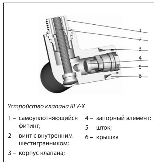
Клапан в сборе представляет собой корпус с двухсторонним самоуплотняющимся фитингом, который имеет два уплотняющих кольца: одно — для уплотнения соединения фитинга с полотенцесушителем, второе — для уплотнения соединения фитинга с корпусом клапана.
