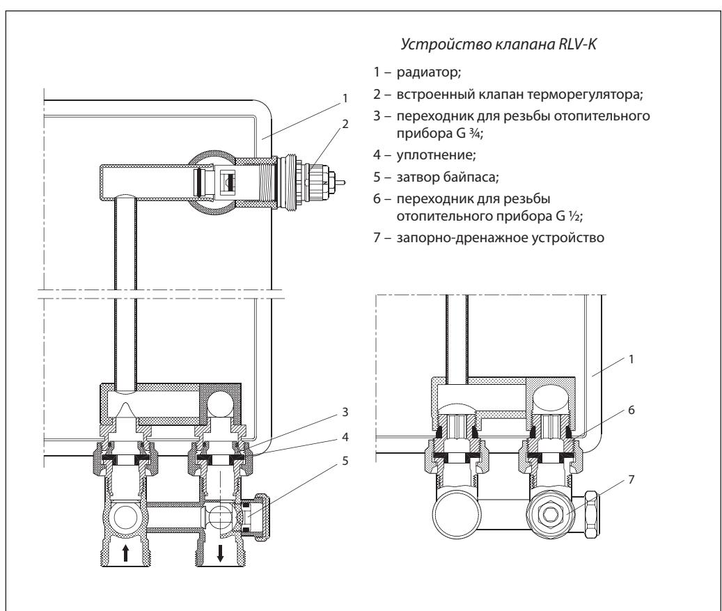
*Устройство клапана RLV-K*
