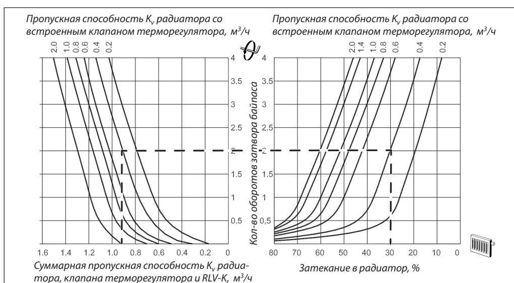
Заводская установка клапана RLV-K предназначена для работы в двухтрубной системе отопления. Это означает, что встроенный байпас клапана закрыт.
