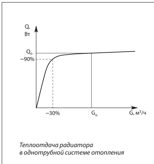
Как показано на рисунке, из-за малого перепада температур теплоносителя в радиаторах однотрубной системы отопления диапазон регулирования их теплоотдачи незначителен (плоская кривая зависимости теплоотдачи от расхода). Это означает, что изменение расхода через радиатор фактически не влияет на его теплоотдачу.
