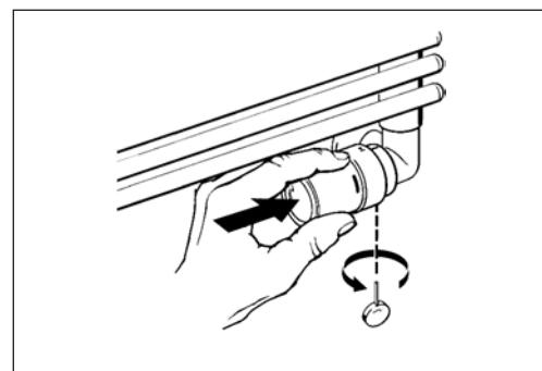
Самоуплотняющийся фитинг монтируется на полотенцесушитель с помощью 17-мм шестигранного ключа.
