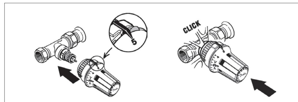
Конструкция корпуса клапана радиаторного терморегулятора предусматривает его монтаж на входном патрубке отопительно-го прибора системы отопления. При этом стрелка на корпусе клапана должна совпадать с направлением движения теплоносителя. В случае применения термоэлемента со встроенным датчиком клапан необходимо устанавливать так, чтобы его шток был в горизонтальном положении.
