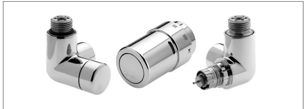
Терморегулирующий комплект X-tra™ специально разработан для полотенцесушителей. Он состоит из клапана терморегулятора, терmostатического элемента и запорного клапана с дренажной функцией. Инновационное самоуплотняющееся присоединение клапанов к радиатору осуществляется с помощью резьбы  $\frac{1}{2}$ ".
