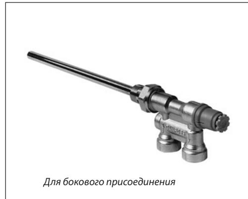
RTR 15/6TB и RTR 15/6T — гарнитуры со встроенным клапаном терморегулятора, предназначенные для «одноместного» присоединения радиатора (через одну пробку) к трубопроводам при их подпольной прокладке соответственно двухтрубной и однотрубной систем отопления.
