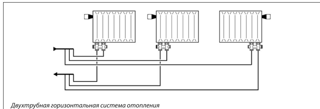
Двухтрубная горизонтальная система отопления
