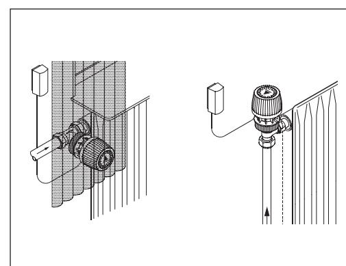
Выносной датчик термостатического элемента необходимо устанавливать на свободной от мебели и занавесок стене или на плинтусе под отопительным прибором, если там нет трубопроводов системы отопления. При монтаже датчика капиллярную трубку следует вытянуть на необходимую длину (максимум на 2 м) и закрепить ее на стене, используя прилагаемые скобки или специальный пистолет.
