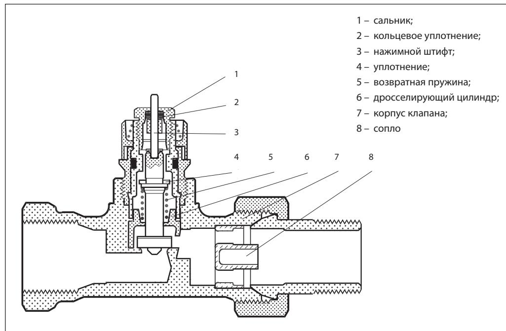
Радиаторный терморегулятор состоит из двух частей: универсального терmostатического элемента серии RTR и регулирующего клапана с предварительной настройкой RTR-N. Терmostатический элемент и регулирующий клапан заказываются отдельно.
