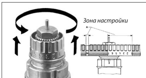
На настроичном устройстве клапана указаны положения настройки от «1» до «7» и буква «N». Настройка может быть выполнена быстро и точно без применения какого-либо инструмента, для этого необходимо:
