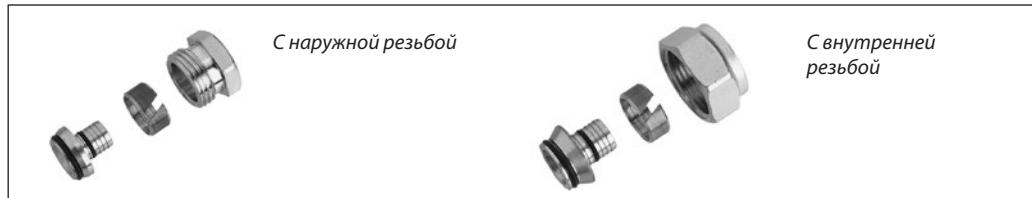
Уплотнительные фитинги предназначены для соединения клапанов терморегуляторов Danfoss и запорно-присоединительных элементов с трубопроводами систем отопления. Они применяются при использовании в системах отопления полимерных труб типа PEX, изготавливаемых в соответствии со стандартом DIN 16892/16893.
