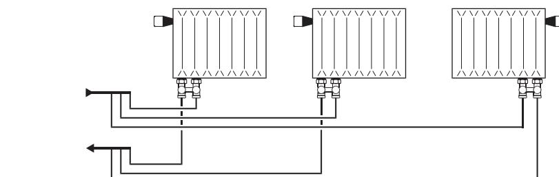
Двухтрубная горизонтальная система отопления
