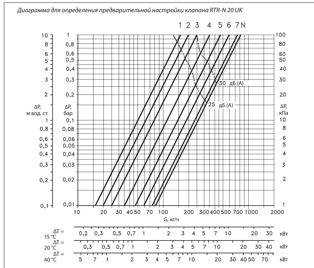
**Пример определения настройки клапана RTR-N**
