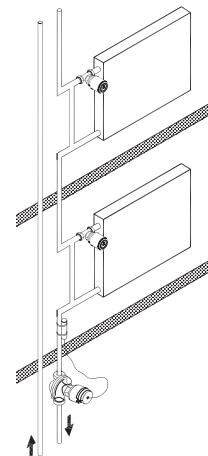
*б — однотрубная система отопления
