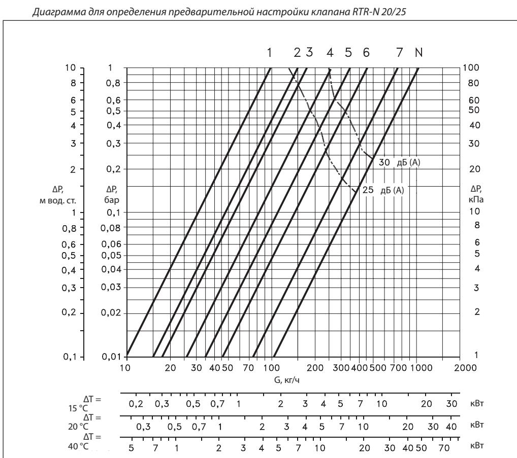
**Определение предварительной настройки клапанов RTR-N и RA-NCX (продолжение)**
