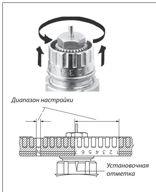
Настройка на расчетное значение производится легко и точно без применения специальных инструментов. Для этого следует:
