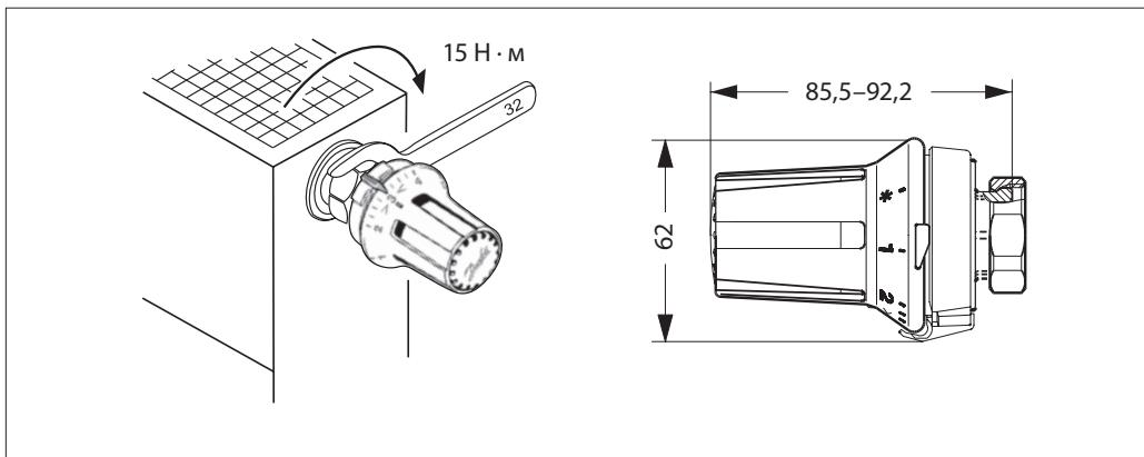
Монтаж термостатического элемента серии RTRW-K на клапан терморегулятора производится легко и быстро с помощью соединительной гайки M 30 x 1,5.
