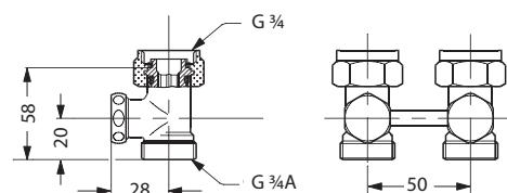
*RLV-KS угловой с присоединением к отопительному прибору G 1/2*
