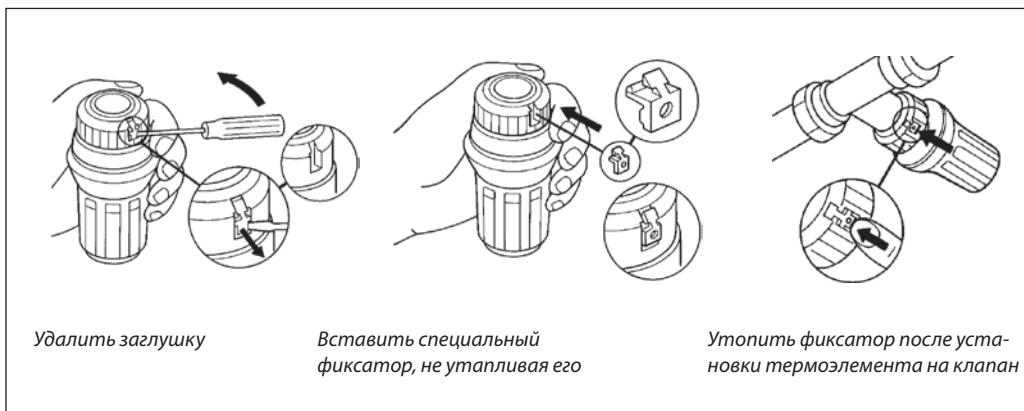
Фиксатор можно удалить с помощью ключа с резьбой (кодовый номер **013G1236**), для этого необходимо:
