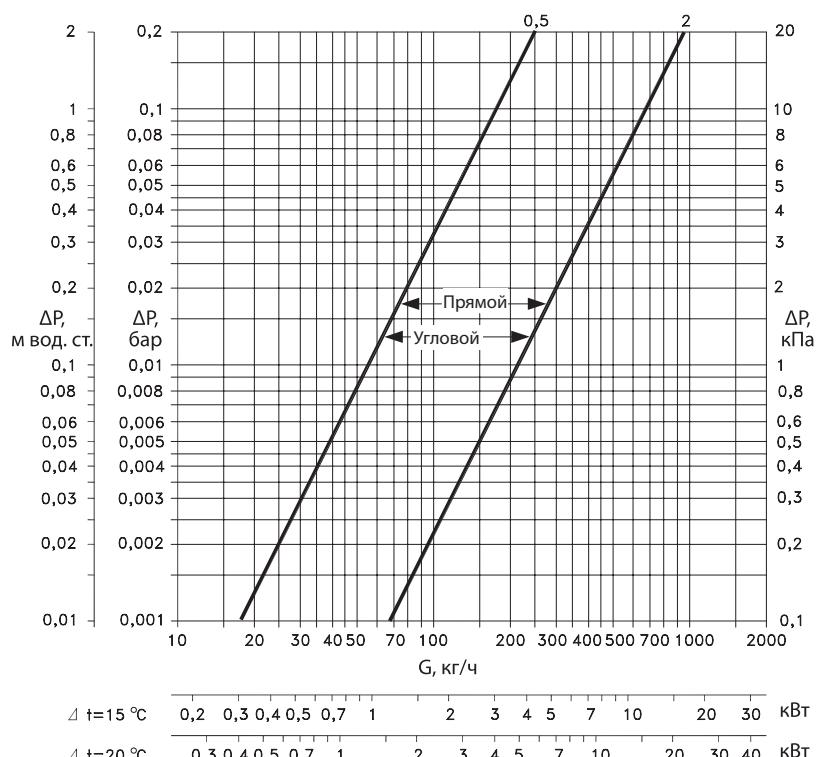
Характеристики приведены для клапанов в комбинации с терmostатическими элементами серии RTR 7000
