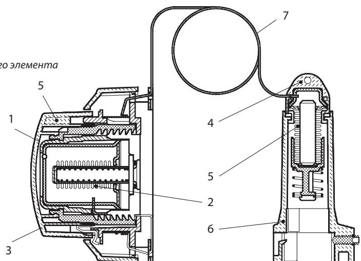
*Устройство термостатического элемента дистанционного управления с выносным датчиком*
