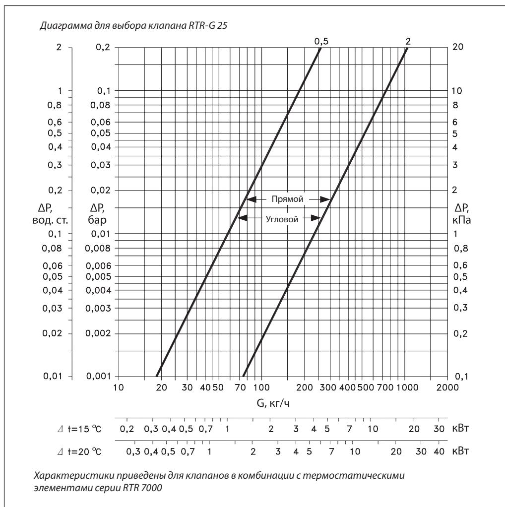
**Пример выбора регулирующего клапана RTR-G**
