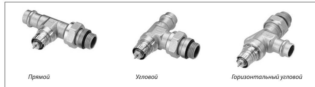
Клапан RA-N предназначен для применения в двухтрубных насосных системах водяного отопления с трубопроводами из меди или нержавеющей стали. Для соединения штуцера клапана с трубопроводом требуются специальные обжимные инструменты.
