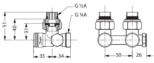
*RLV-K прямой с присоединением к отопительному прибору G 3/4*
