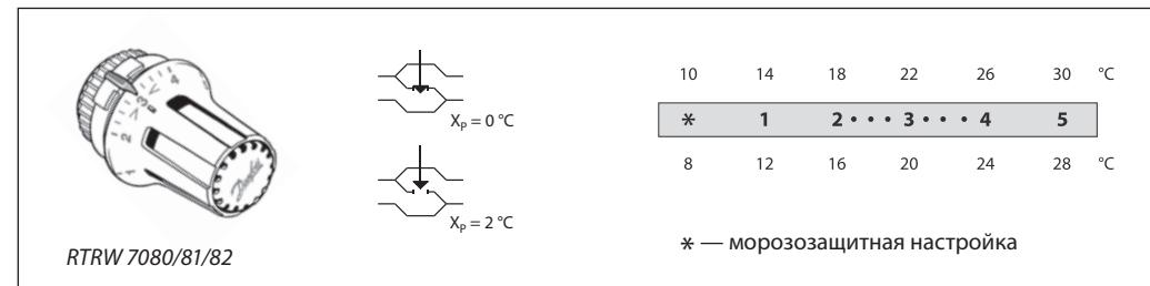
Термостатический элемент настраивается на требуемую комнатную температуру поворотом его рукоятки с нанесенной на нее цифровой шкалой. Цифры на шкале корреспондируют с поддерживаемой регулятором температурой воздуха в помещении. Их соотношение показано на рисунке. Указанные величины являются ориентировочными, так как фактическая температура в помещении
