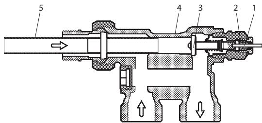
RTR 15/6T для однотрубной системы отопления
