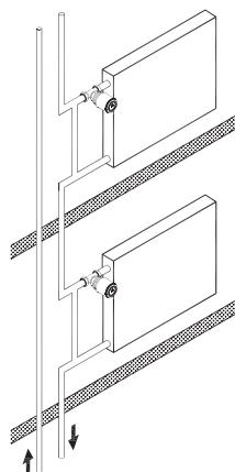
*a – вертикальная система с верхней подачей теплоносителя*
