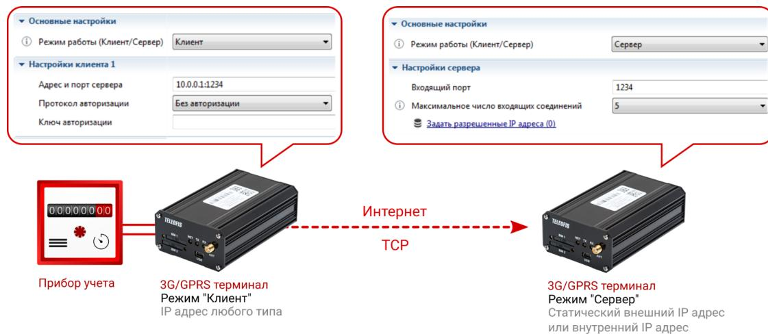
Рис. 19. Схема подключения WRX «Клиент» - WRX «Сервер».
