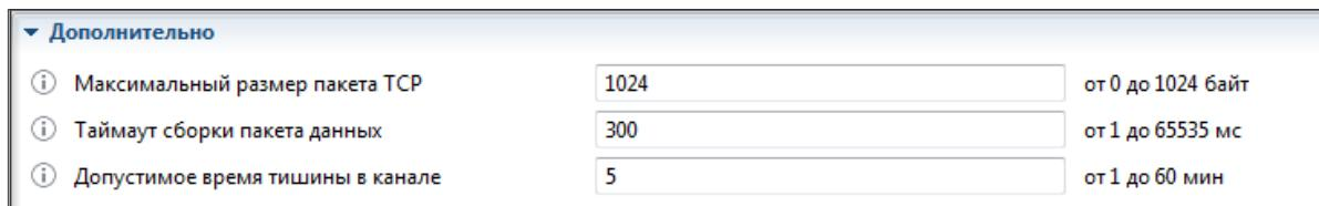
Рис. 49. Дополнительные настройка рабочего режима.
