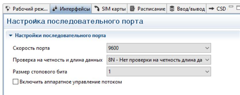
Рис. 50. Настройка последовательного порта.
