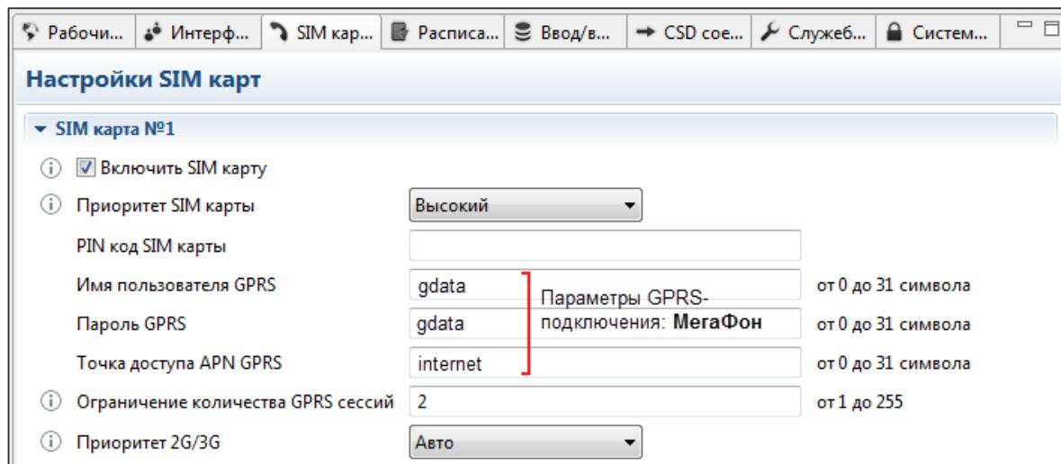
Рис. 39. Настойка параметров SIM.
