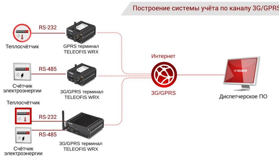
Рис. 2. Построение системы учёта с применением терминалов WRX.
