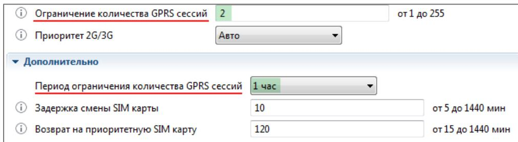
Рис. 40. Настройка SIM. Ограничение количества GPRS-сессий
