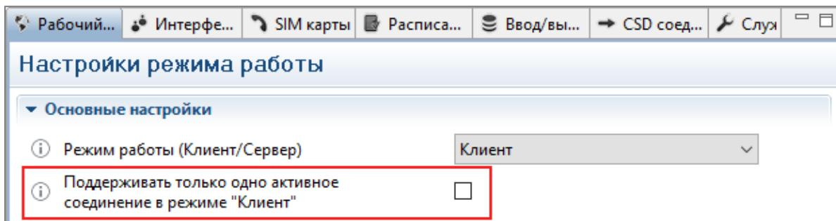
Рис. 45. Установка одного активного соединения в режиме Клиент.
