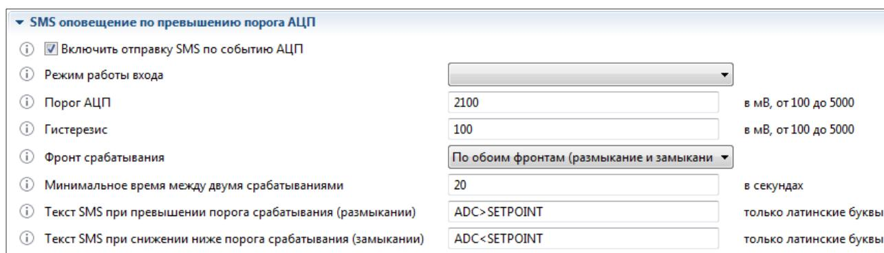
Рис. 52. Настройка SMS-уведомлений о событиях на входе.
