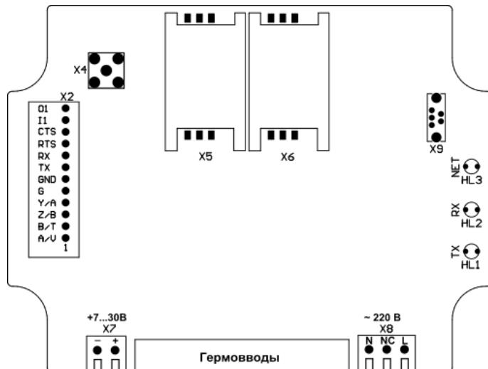
Рис. 16. Разъёмы терминалов герметичного исполнения.
