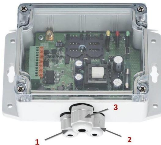
Рис. 17. Обозначение гермовводов.
