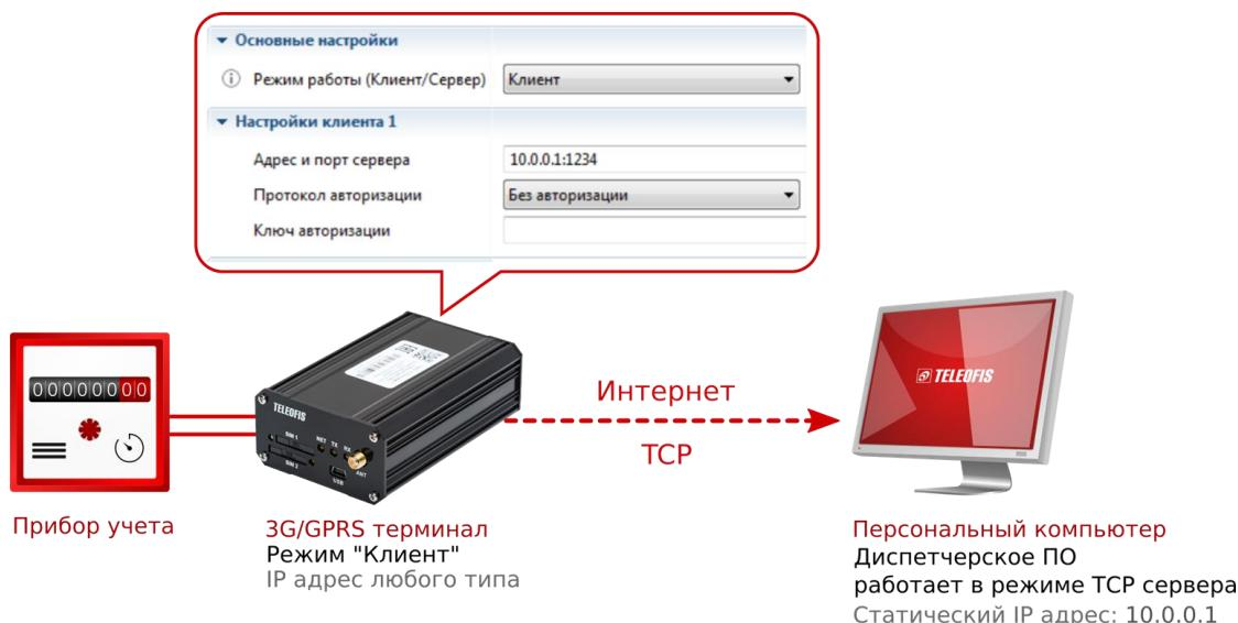
Рис. 18. Схема подключения WRX «Клиент» - ПК «Сервер».
