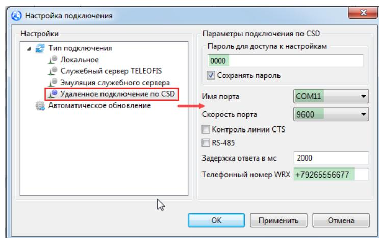
Рис. 36. Настойка подключения по CSD.
