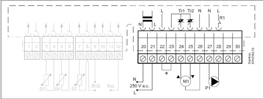
\* Резервные клеммы для предохранительного термостата
