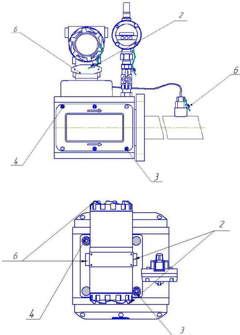
Рисунок Е.3 – Схема пломбирования расходомера Turbo Flow UFG-F исполнение корпуса С, CR
