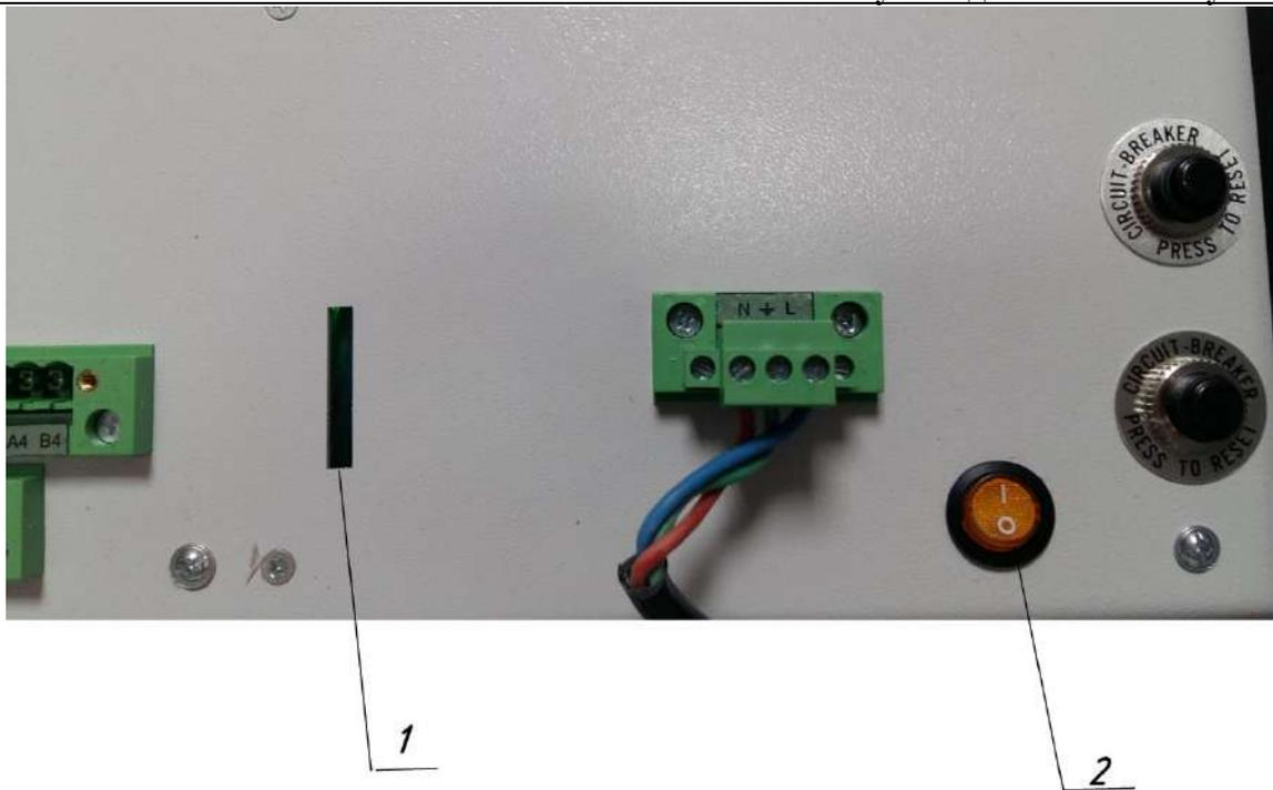
1 – прорезь для SIM-карты; 2 – кнопка включения резервного источника питания
