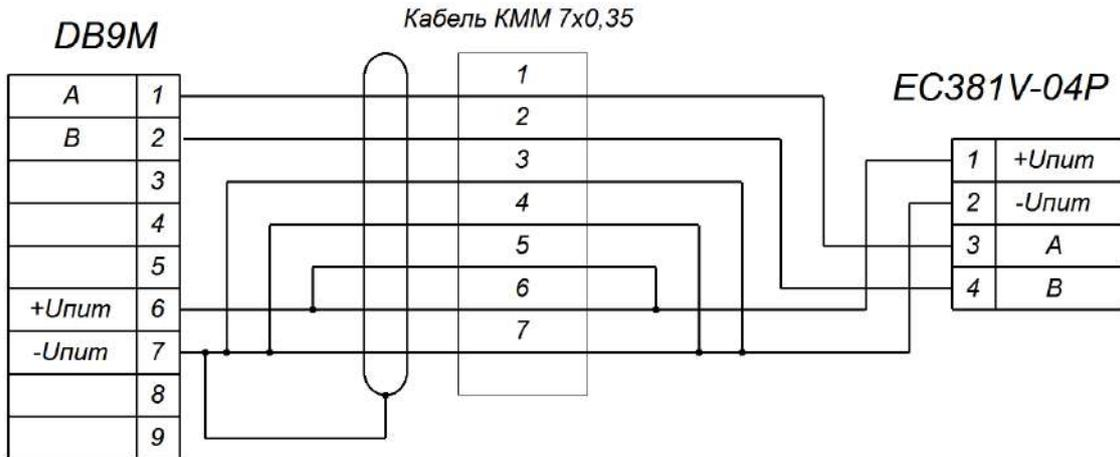
Рисунок Г.1 – Схема распайки кабеля КММ 7×0,35
