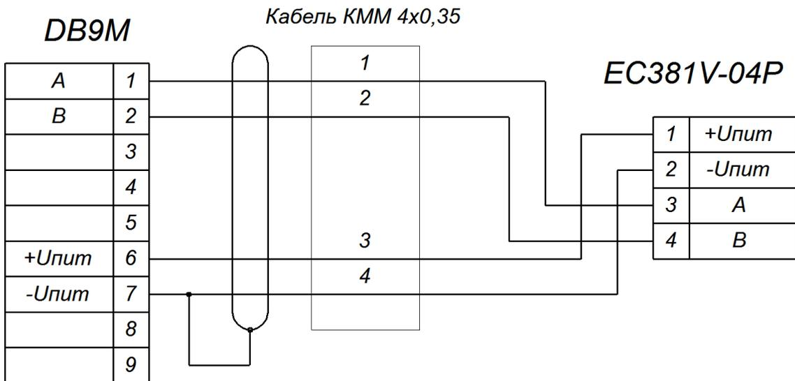
Рисунок Г.1.1 – Схема распайки кабеля КММ 4×0,35
