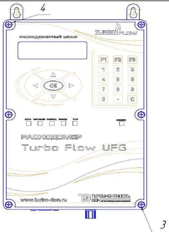
Рисунок Е.4 – Схема пломбирования расходомерного шкафа
