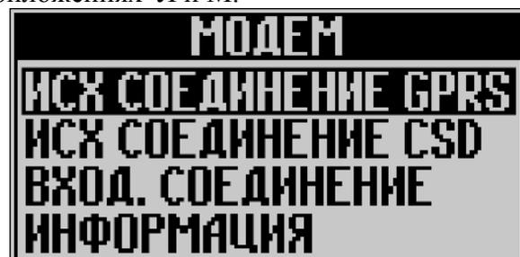
– при включении модема в режиме «Входящее соединение» он включается на 10 мин для принятия входящих соединений по протоколам GPRS; CSD и на экране появляется сообщение о соединении;
