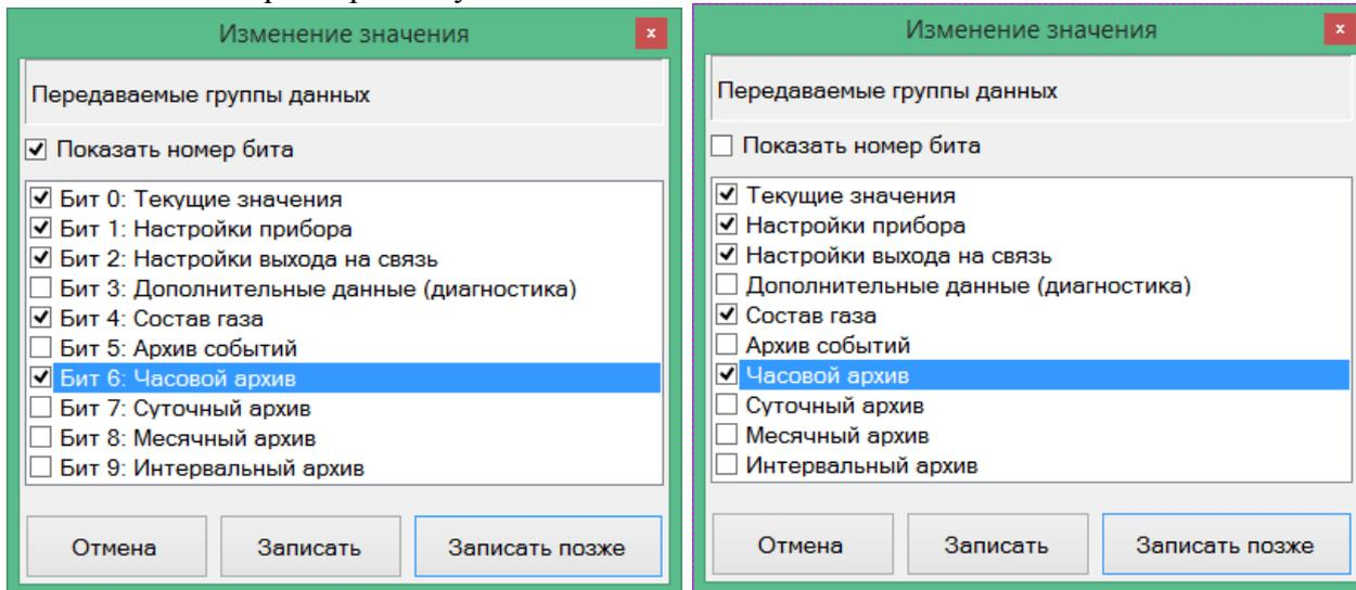
Рисунок М.18. Пример задания групп передаваемых данных (слева - с указанием номеров битов в битовой маске, справа - без указания номеров битов)
