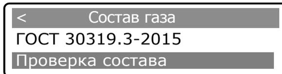
Если компонентный состав газа соответствует выбранному методу, то отображается сообщение «Состав газа соответствует». Если компонентный состав газа не соответствует выбранному методу, то отображается сообщение «Ошибка. Сумма компонентов х.ххх%».
