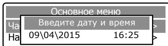
В открывшемся окне установить текущую дату и время. Переключение в режим редактирования осуществляется с помощью повторного нажатия клавиши [ВВОД]. Установка времени / даты осуществляется с помощью клавиш [ 0 ] - [ 9 ], перемещение между цифрами – с помощью клавиш [ ← ] [ → ]. Активная цифра выделяется подчеркиванием.
