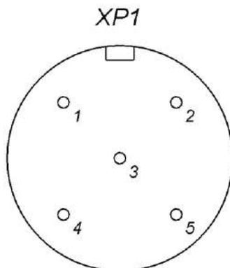
Рисунок Г.4 – Разъемы для подключения датчика давления
