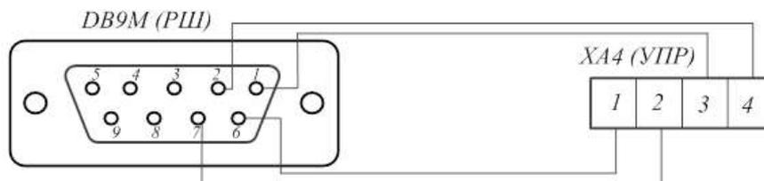
Рисунок Г.3 – Схема подключений РШ и УПР
