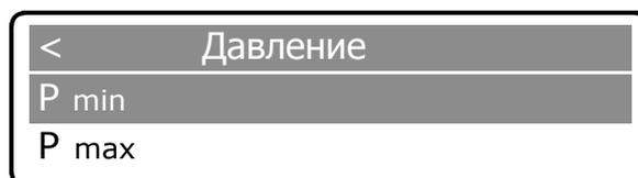
Ввод минимального значения давления выполняется в следующей последовательности: Клавишами [↑] [↓] выбрать параметр «Pmin» и подтвердить нажатием [ВВОД].
