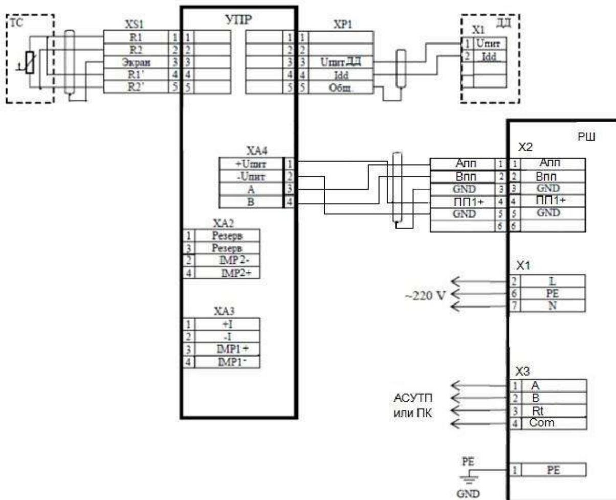
Рисунок Г.7 – Схема подключения РШ с БПИ к УПР
