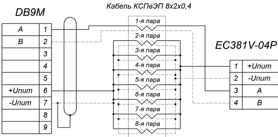
Рисунок Г.2 – Схема распайки кабеля КСПвЭП 8×2×0,4
