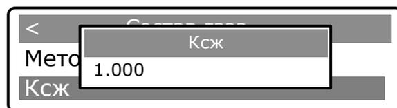
– переключение в режим редактирования осуществляется с помощью повторного нажатия клавиши [ВВОД], после чего активная цифра выделяется подчеркиванием. Изменение значений осуществляется с помощью клавиш [ 0 ]-[ 9 ], перемещение между цифрами – с помощью клавиш [ ← ] [ → ].
