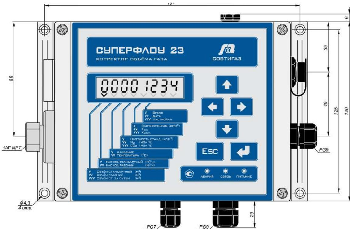
Рисунок Б.9 – Внешний вид корректора «Суперфлоу 23»
