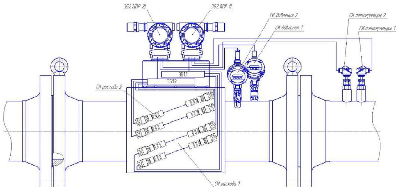
Рисунок Б.7 – Дублирование средств измерения расхода, вычислительных средств и СИ температуры и давления (исполнение C1TR, C2TR)
