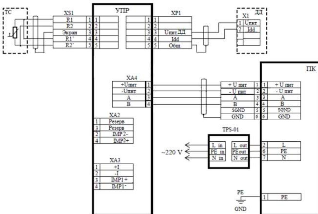
Рисунок В.2 – Схема подключения УПР с ПК
