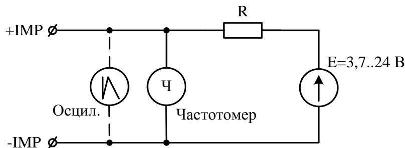
Рисунок 4.9 Схема подключения приборов для проверки частотных выходов
