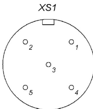
Рисунок Г.5 – Разъемы для подключения термосопротивления
