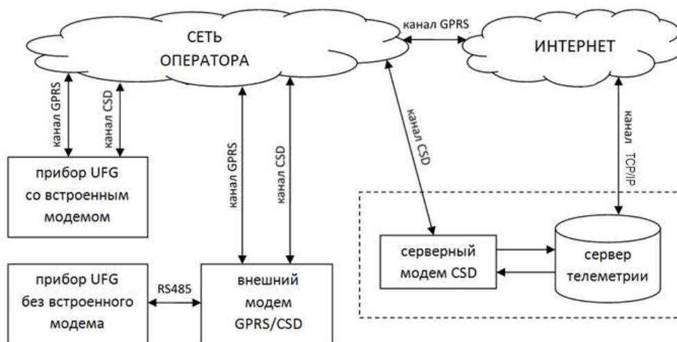
Рисунок М.1. Структурная схема соединений по каналам CSD и GPRS при использовании встроенного модема прибора UFG и модема CSD на сервере АСКУГ
