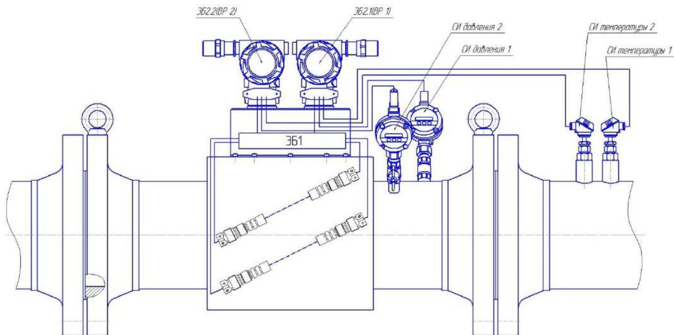
Рисунок Б.6 – Дублирование вычислительных средств и СИ температуры и давления (исполнение C1TR, C2TR)
