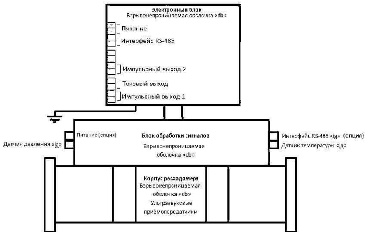
Рисунок И.1 – Схема обеспечения искробезопасности 1Ex db ib [ia Ga] IIC T4 Gb или 1Ex db [ia Ga] IIC T4 Gb, или 1Ex db ma ib [ia Ga] IIC T4 Gb, или 1Ex db ma [ia Ga] IIC T4 Gb
