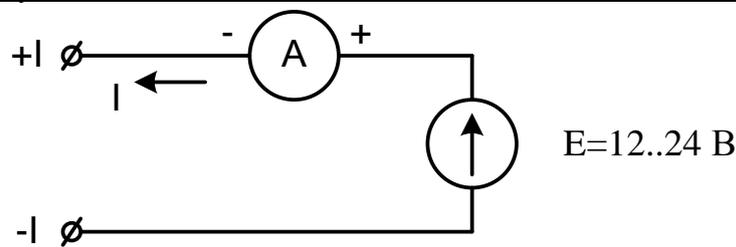
Рисунок 4.6 Схема подключения приборов для проверки токового выхода
