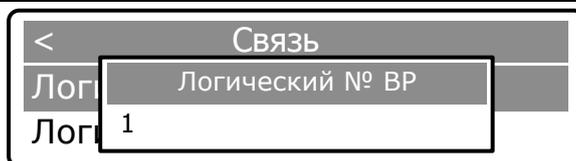
Ввод параметра осуществляется с помощью повторного нажатия клавиши [ВВОД], после чего активная цифра выделяется подчеркиванием (режим редактирования). Изменение значений – клавишами [ 0 ]-[ 9 ], перемещение между цифрами – с помощью клавиш [ ← ] [ → ].
