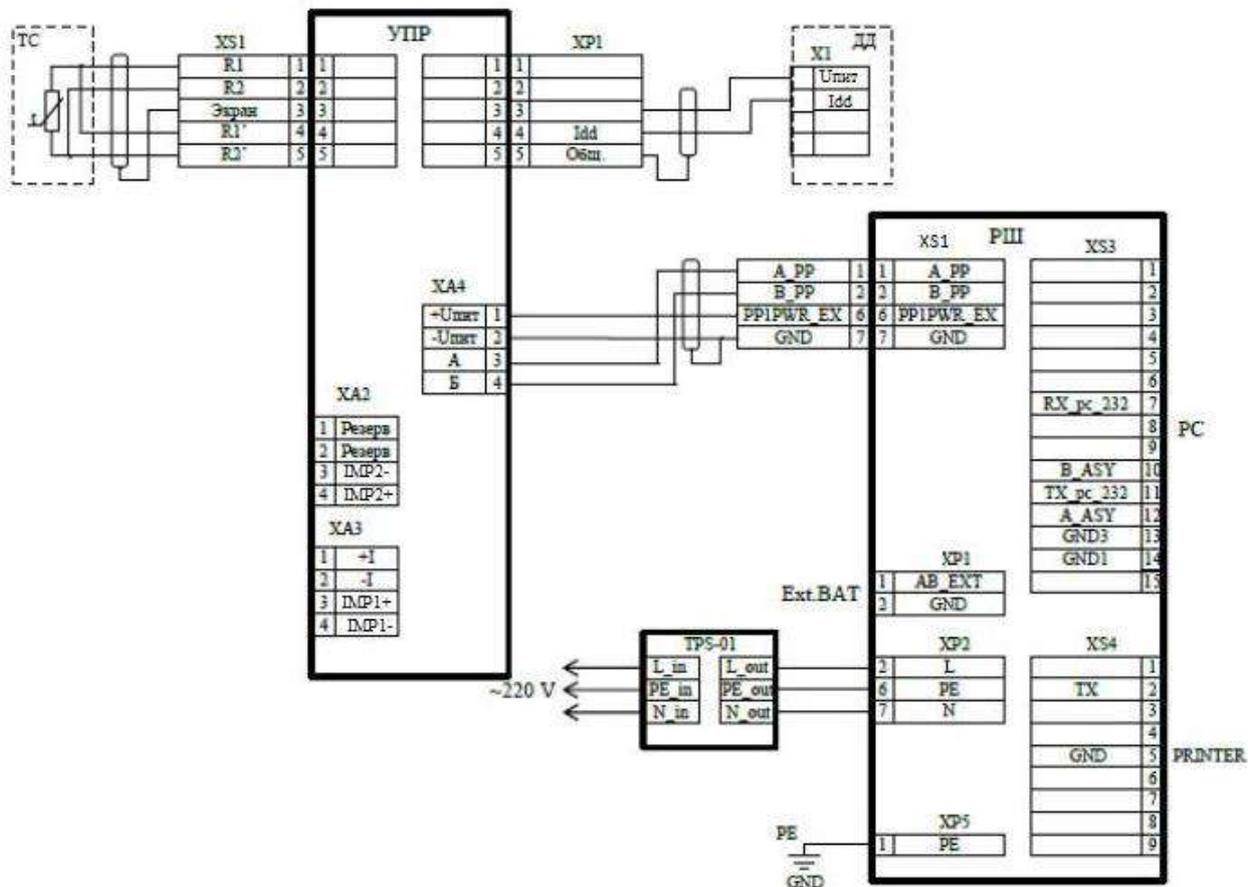
Рисунок В.1 – Схема подключения расходомера
