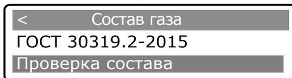
Если компонентный состав газа соответствует выбранному методу, то отображается сообщение «Состав газа соответствует». Если компонентный состав газа не соответствует выбранному методу, то отображается сообщение «Ошибка. Сумма компонентов х.ххх%».
