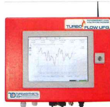
Расходомерный шкаф с промышленным компьютером
