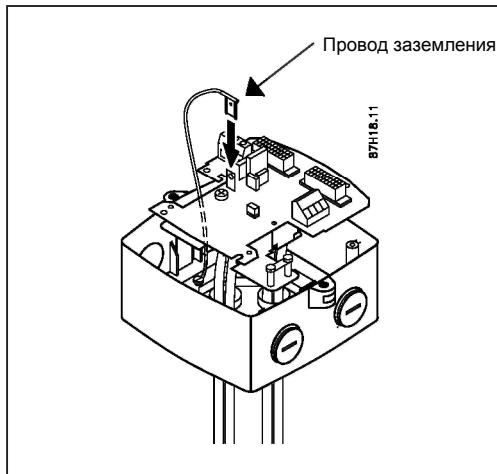
В модулях с питанием от сети провод защитного заземления должен быть подключен к PE  $\ominus$  на печатной плате с помощью коннектора.
