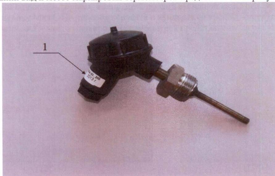
Рисунок 1 – Внешний вид термометра платинового технического ТПТ-20.
