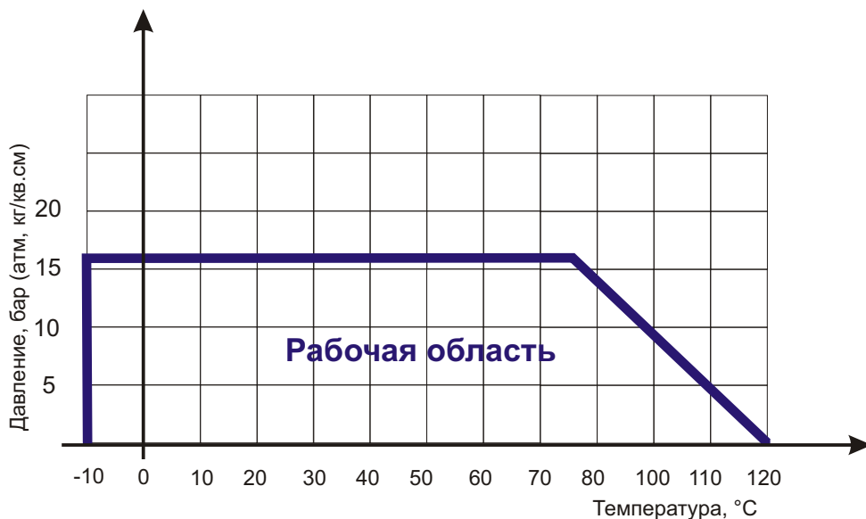
Диаграмма Давление / Температура для задвижки клиновой ABRA-A40-16G с обрезиненным клином и невыдвижным штоком Ду40-600 Ру16:
