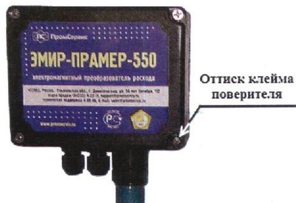
Рисунок 4 – Место пломбирования ЭП в пластиковом корпусе
