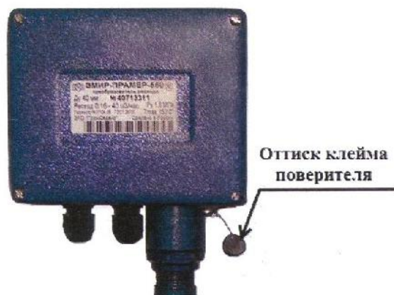
Рисунок 3 – Место пломбирования ЭП в стальном корпусе
