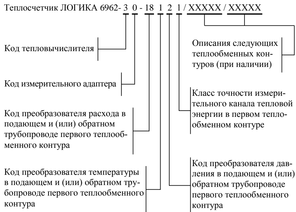
Рисунок 2.1 – Структура обозначения теплосчетчиков
