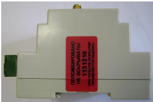
Рисунок 3.31 – Наклейка пломба на МПД-1
