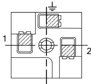
Расположение контактов на розетке разъема со стороны винтового закрепления проводников (Разъем в соответствии DIN43650С серии GDM с 3 контактами).
