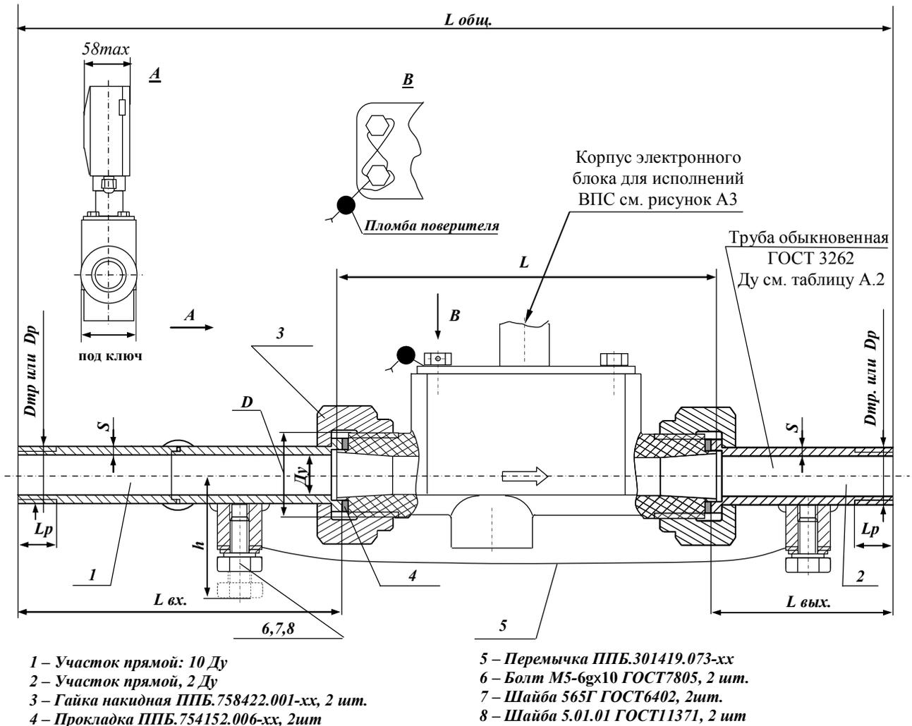
**Рисунок А.5 – Габаритные и присоединительные размеры преобразователей ВПС с комплектом монтажных частей (в соответствии с таблицей А.3)**
