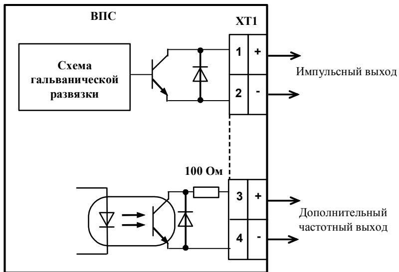
Рисунок Б.1 – Схемы выходных цепей преобразователей ВПС1(2)-ЧИХ.XX
