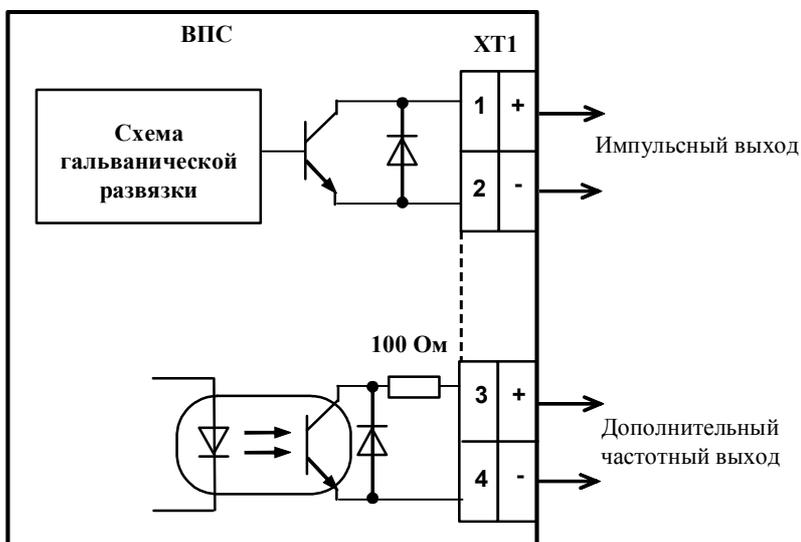
Рисунок Б.1 – Схемы выходных цепей преобразователей ВПС1(2)-ЧИХ.ХХ
