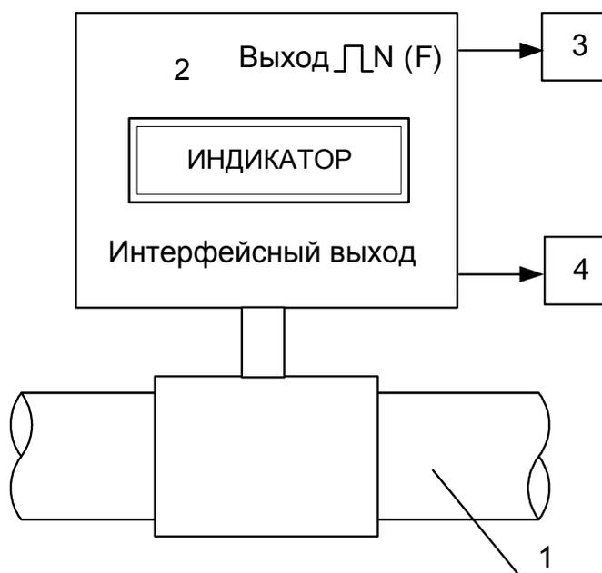
1 – трубопровод поверочной установки; 2 – расходомер; 3 – счетчик импульсов (частотомер); 4 – персональный компьютер.
