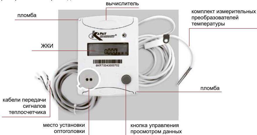
Рисунок 4 — Измерительная часть теплосчетчика
