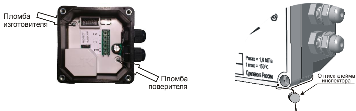
Рисунок 4 - Места пломбирования ЭБ исполнения 1
