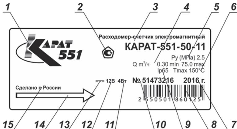
Рисунок 1.9 – Маркировка на шильдике расходомера
