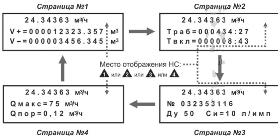
Рисунок 1.8 – Пример отображения индикации на ЖКИ прибора
