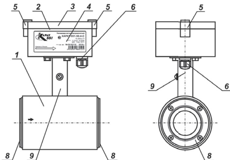
1 – проточная часть; 2 – электронный преобразователь; 3 – крышка корпуса электронного преобразователя; 4 – шильдик (маркировочная табличка); 5 – приливы для пломбирования; 6 – кабельный ввод; 7 – фланцы присоединительные; 8 – кольца защитные; 9 – стойка-соединитель
