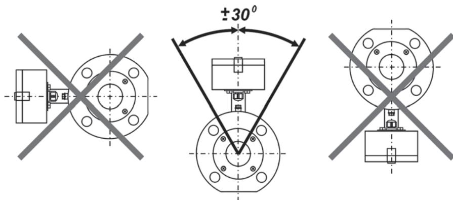
Рисунок Б.2 – Допускаемая ориентация расходомера при установке в трубопровод
