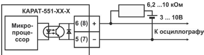
**Рисунок 3.1** – Контроль импульсного выходного сигнала
