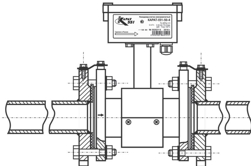
Рисунок В.1 – Установка в трубопровод фланцевых расходомеров
