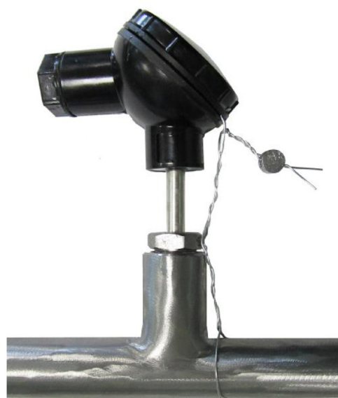
Рисунок 6 - Схема пломбировки ТС (головка типа DL)
