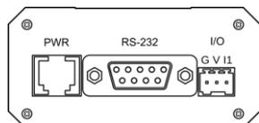
**TELEOFIS WRX 700-R4** – 2G-терминал с последовательным интерфейсом **RS-232**.
