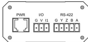
**TELEOFIS WRX 712-L4** – терминал с последовательным интерфейсом **RS-422**.
