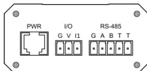
**TELEOFIS WRX708-R4/L4, WRX908-R4/L4** – терминалы с промышленным интерфейсом **RS-485**.
