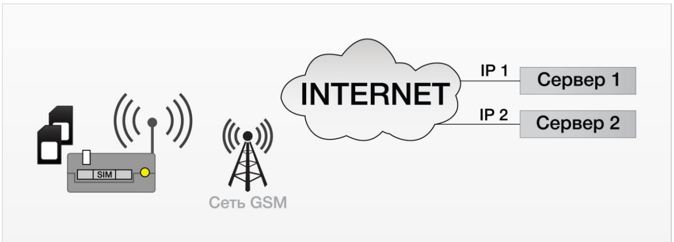
Рис. 4.3 Схема работы с двумя серверами
