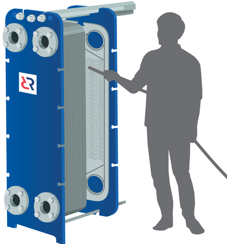
Рисунок В.1 – Схема очистки теплообменника водой под давлением и щеткой
