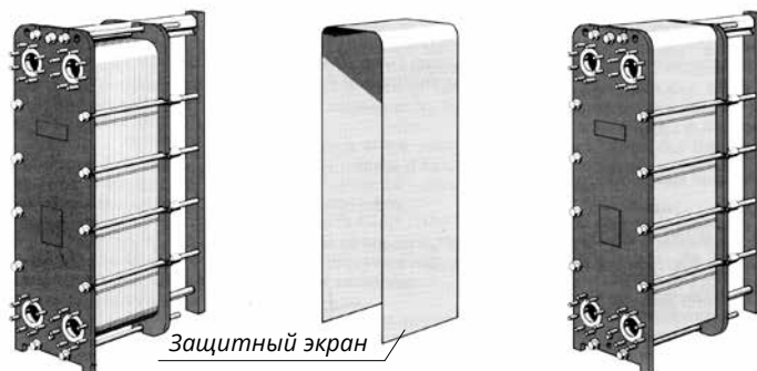
Рисунок А.6 – Схема установки защитного экрана
