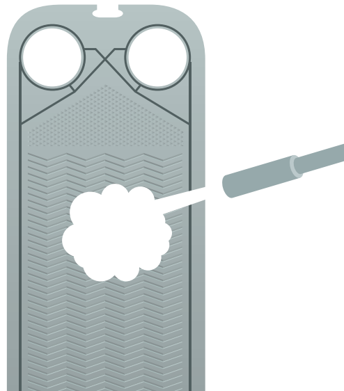
Рисунок В.3 – Схема очистки теплообменника водой под давлением
