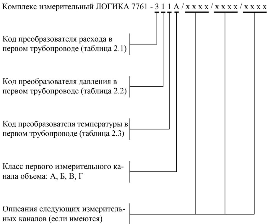
Рисунок 2.1 – Структура обозначения исполнений ИК
