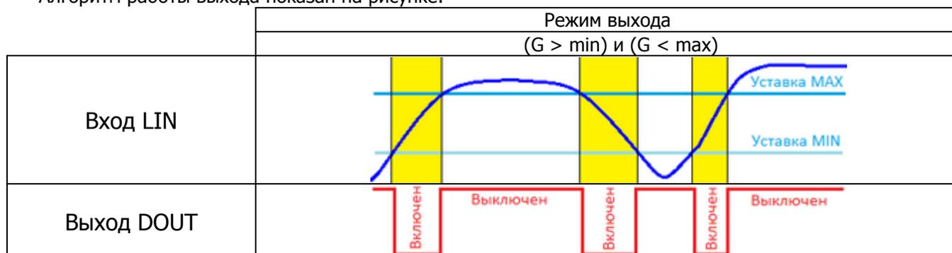
**Примечание** При установке признака «+Отсутствие измерений» в настройках дискретный выход переводится в состояние «Включен» при неисправности, выявленной системой внутренней диагностики расходомера, а также при отсутствии связи с расходомером по каналу LIN.
