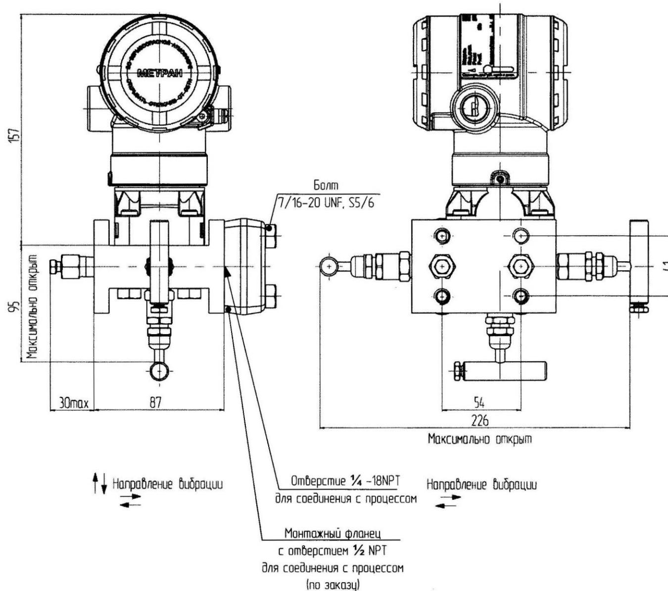
Рисунок М.15 - Датчик модели 150CDR с установленным 3-х вентильным клапанным блоком 305RT (код S5).
