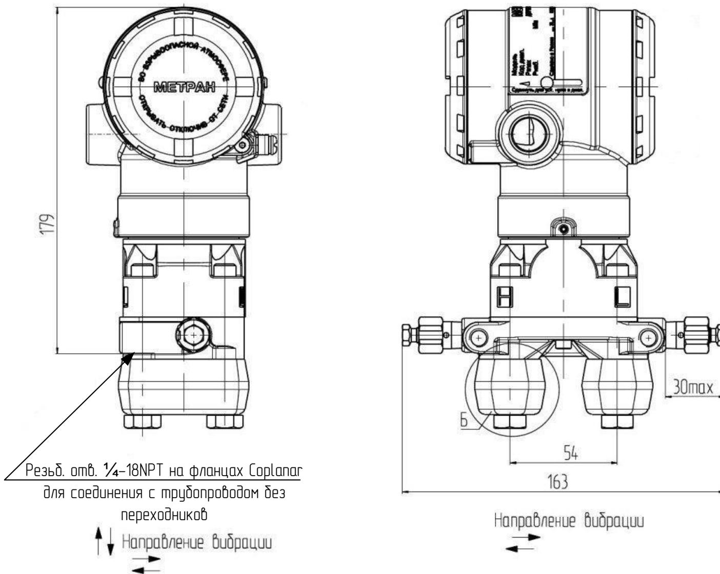
Рисунок М.10 - Датчик модели 150CDR с фланцем coplanar и установленным монтажным фланцем 1/2NPT (код D4).
