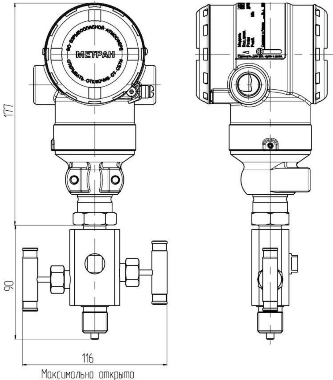
Рисунок М.23 - Датчики моделей 150TGR,TAR с кодом 2G и установленным
