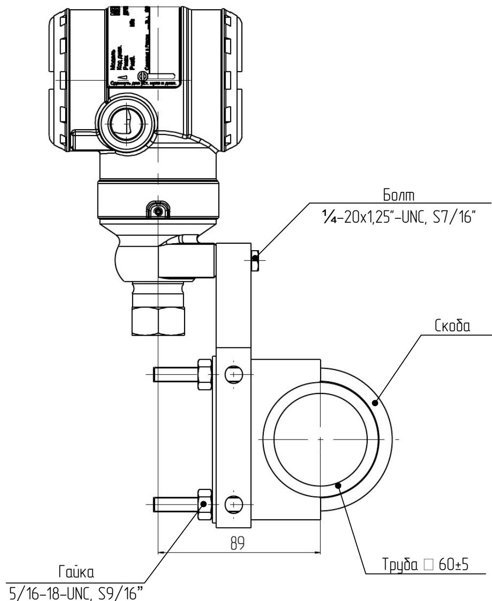
Рисунок М.27 - Датчики моделей 150TGR,TAR с установленным монтажным кронштейном для монтажа на трубе (код В4). Остальное см. рисунок М.8
