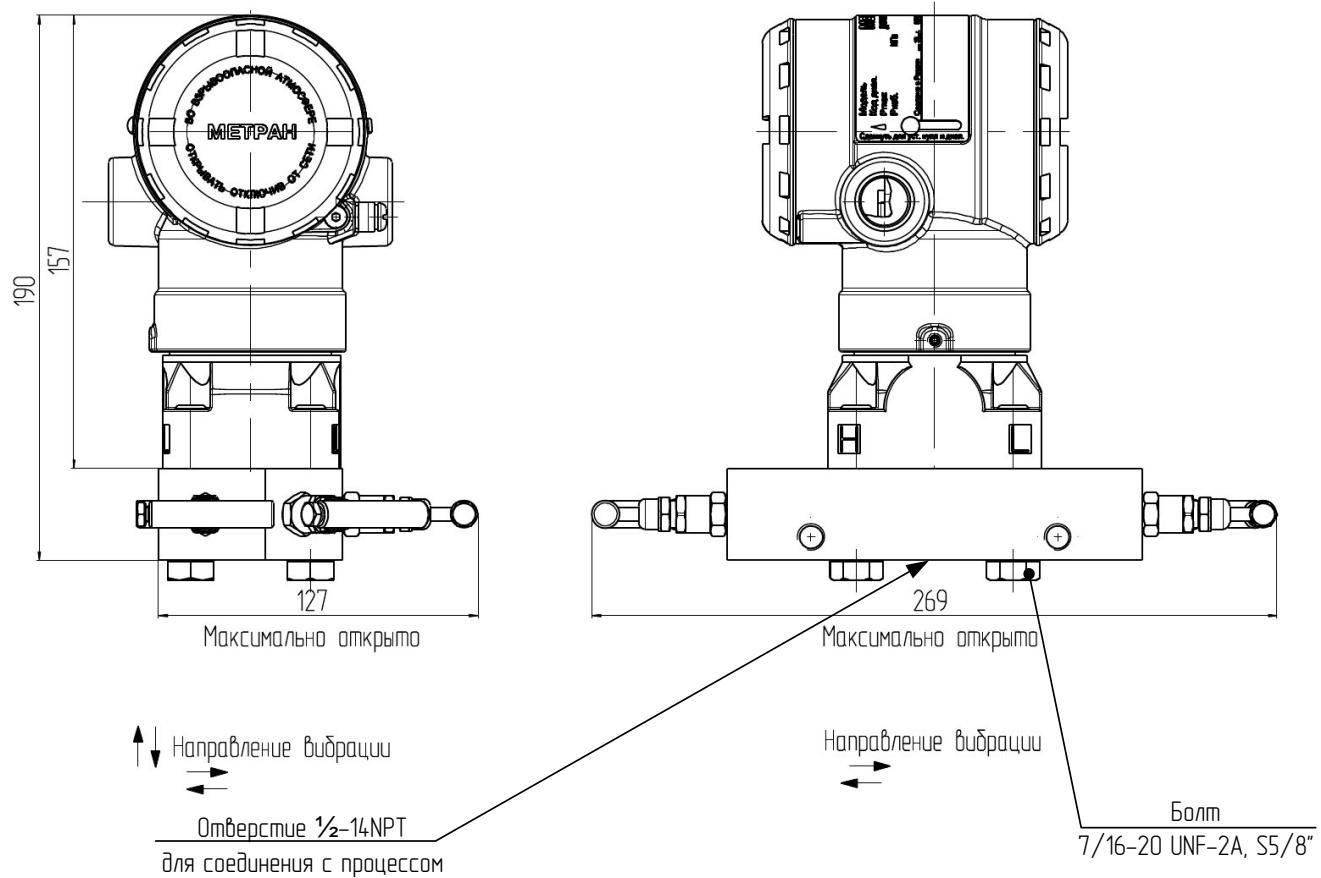
Рисунок М.12 - Датчик модели 150CDR с установленным 5-ти вентильным
