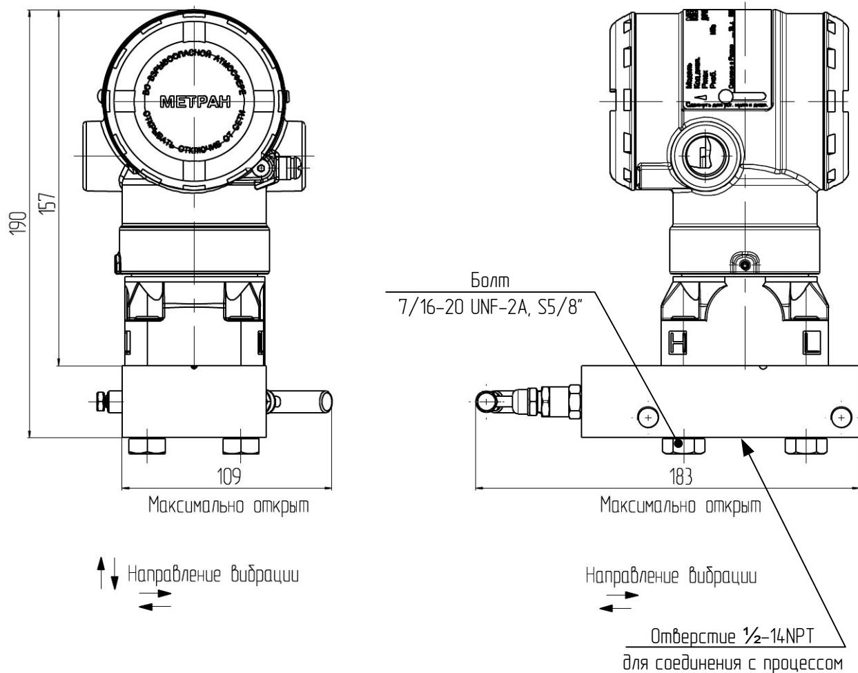
Рисунок М.13 - Датчик модели 150CGR с установленным 2-х вентильным клапанным блоком 305RC (код S5). Остальное см. рисунок М.8
