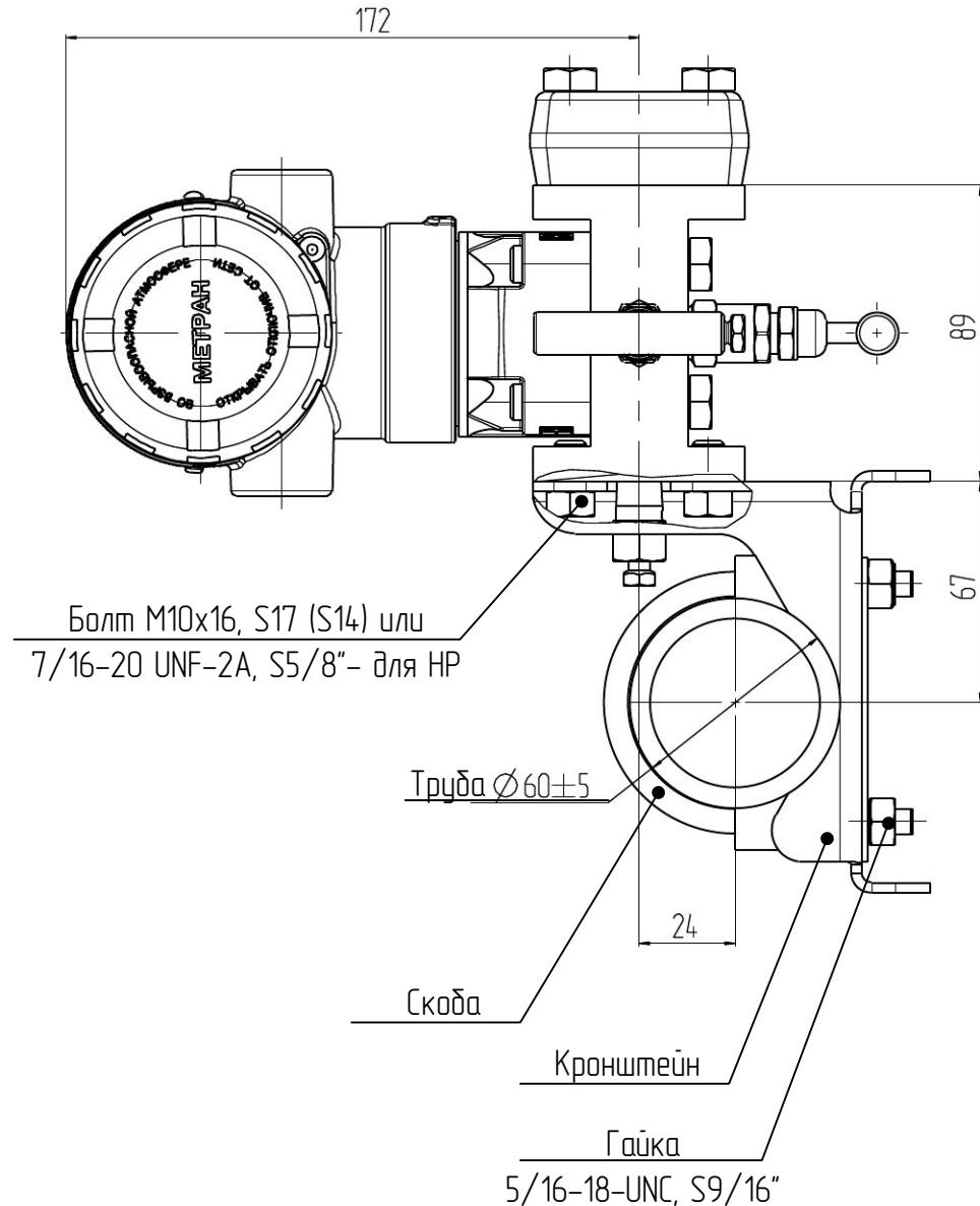
Рисунок М.19 – Датчики моделей 150CDR, 150CGR с установленным монтажным кронштейном (код В1). Остальное см. рисунок М.8
