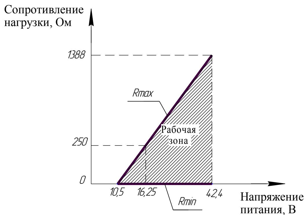
$R_{min}=250\text{Ом}$  – для датчиков с HART-сигналом
