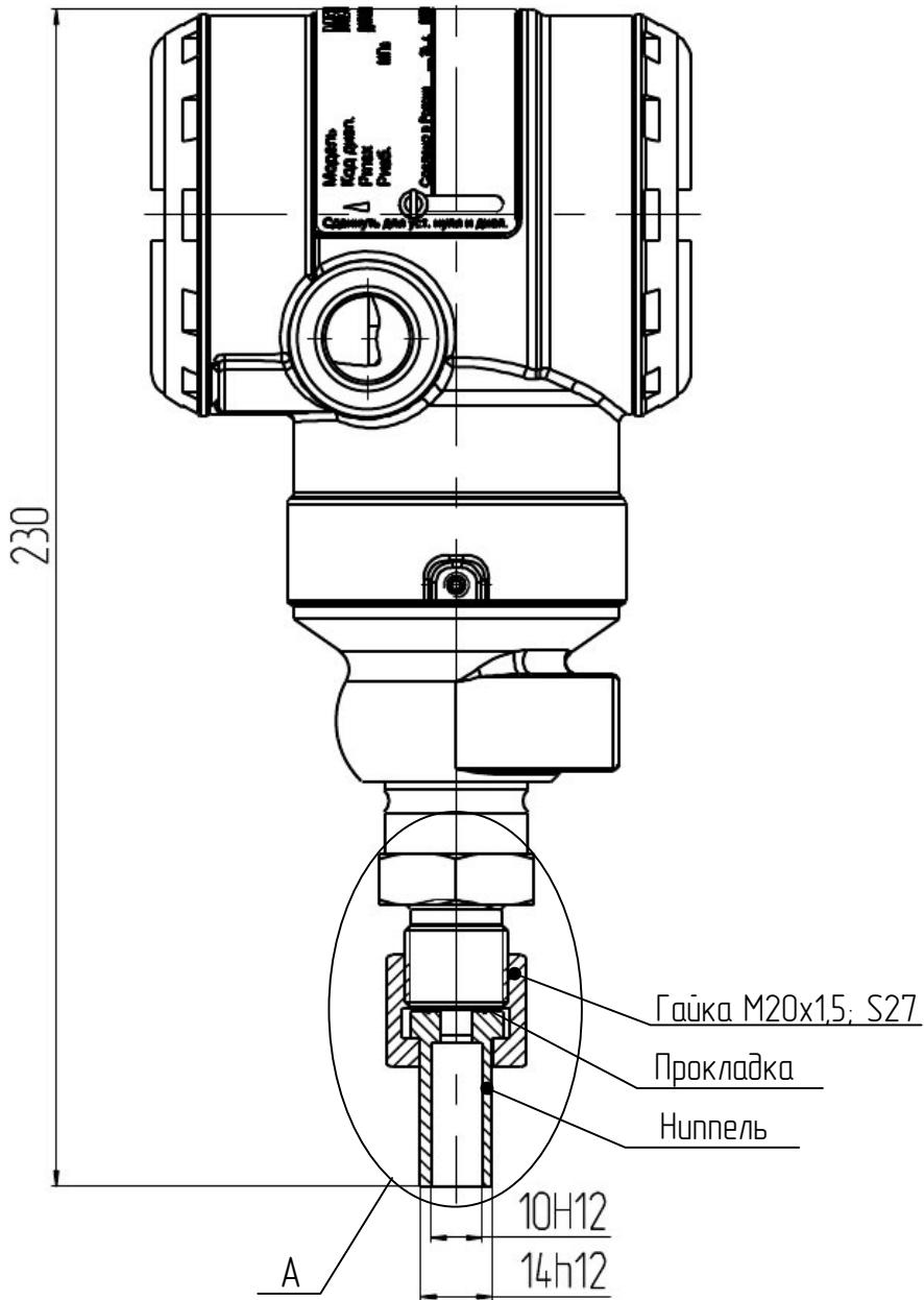
Рисунок М.20 - Датчики моделей 150TGR,TAR с установленным ниппелем и
