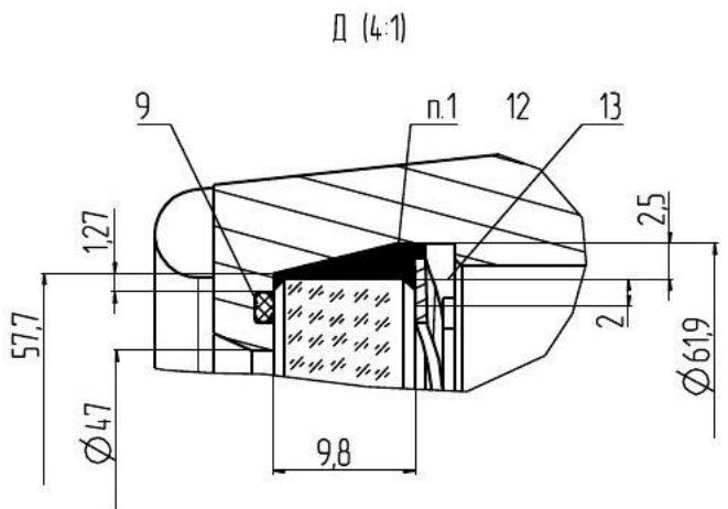
1 – Сенсорный модуль; 2 – Корпус; 3, 4 – Крышка; 5 – Диск (стекло); 6-9 – Кольцо уплотнительное; 11 – Винт; 12 – Кольцо волновое; 13 - Кольцо; 14 –Узел внешнего заземления.
