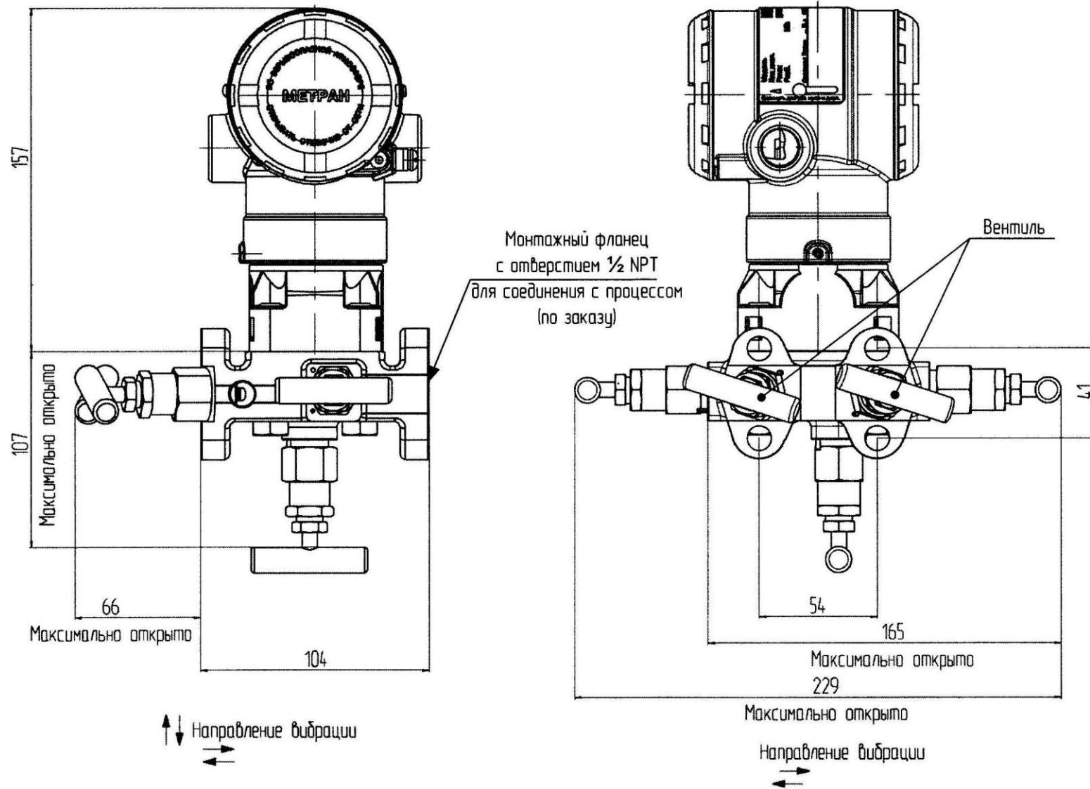
Рисунок М.17 - Датчик модели 150CDR с установленным 5-ти вентильным клапанным блоком 305RM (код S5).
