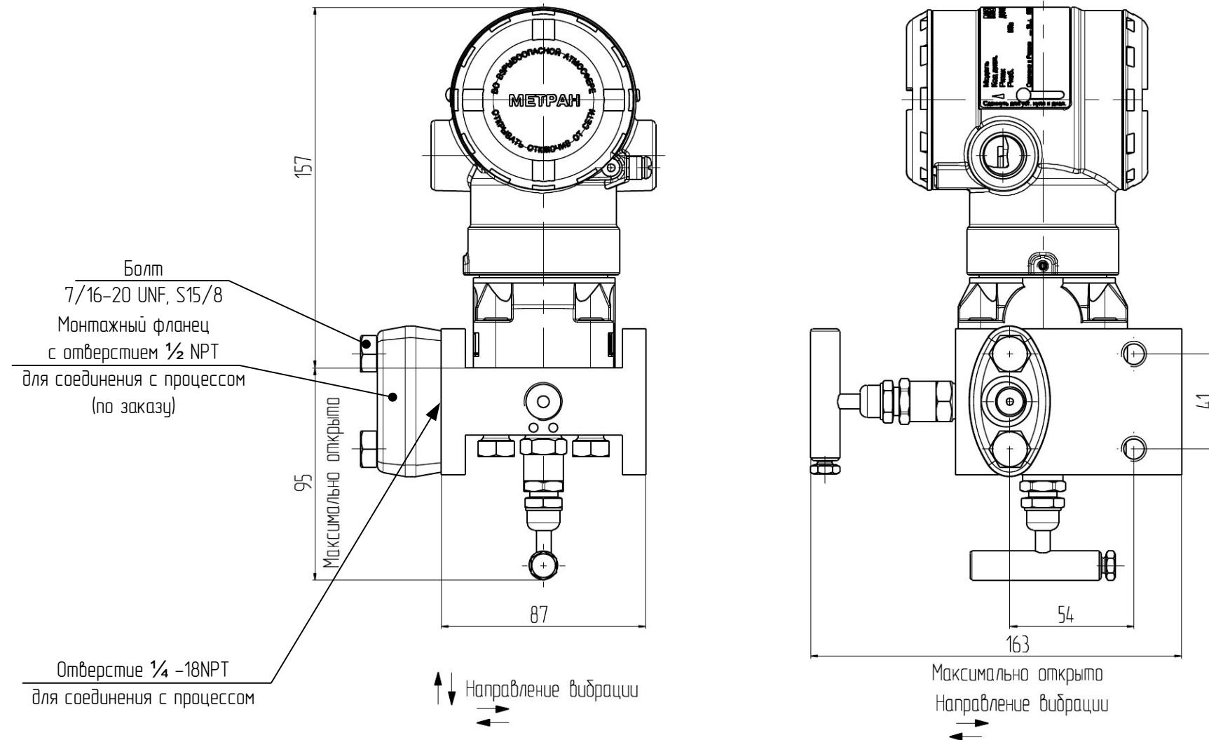
Рисунок М.14 - Датчик модели 150CGR с установленным 2-х вентильным клапанным блоком 305RT (код S5).
