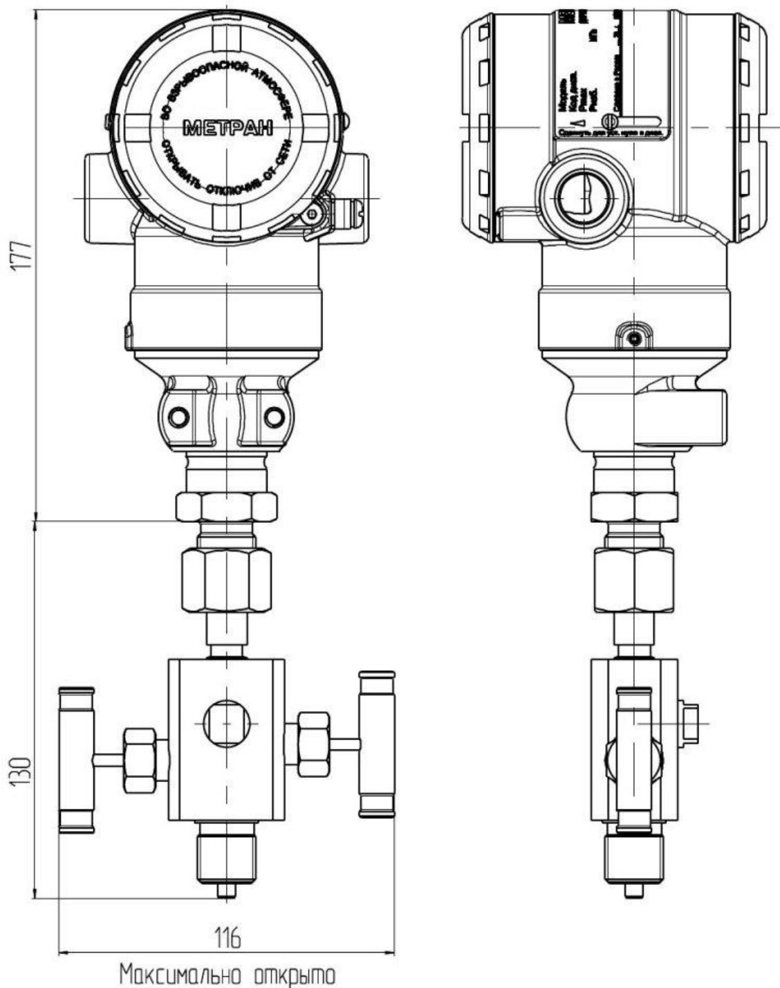
Рисунок М.22 - Датчики моделей 150TGR,TAR с кодом 2G и установленным клапанным блоком Метран серии Е. Остальное см. рисунок М.8
