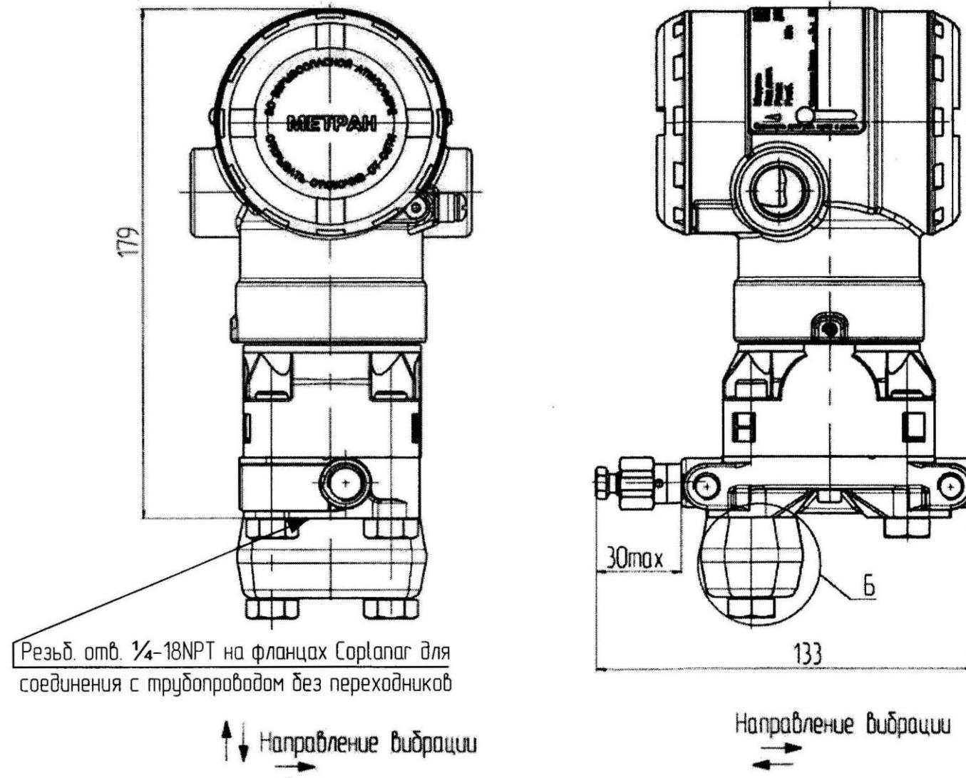
Рисунок М.11 - Датчик модели 150CGR с фланцем coplanar и установленным фланцем 1/2NPT (код D4).
