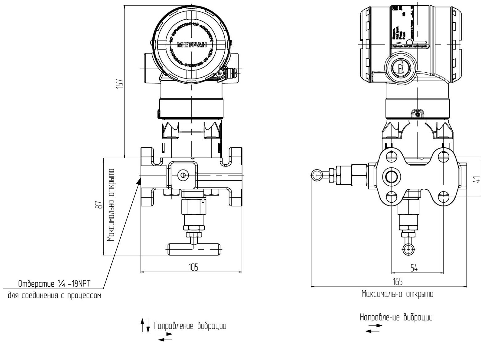
Рисунок М.16 - Датчик модели 150CGR с установленным 2-х вентильным клапанным блоком 305RM (код S5).
