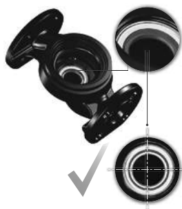
Рис. 15 Правильно выровненная система уплотнений
