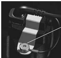
Рис. 44 Заземляющий провод датчика
