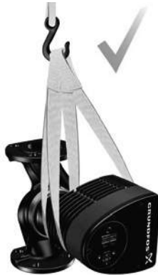
Рис. 7 Правильный способ строповки насоса
