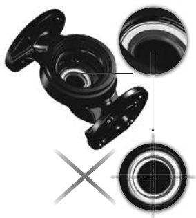
Рис. 16 Неправильно выровненная система уплотнений
