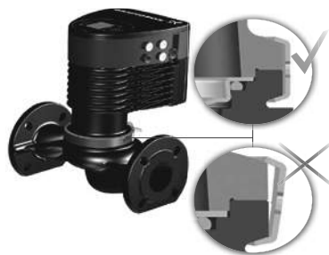
Рис. 17 Закрепление головной части насоса на корпусе
