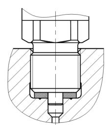
Рисунок В.2 — Установка преобразователей на рабочей магистрали
