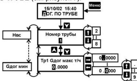
Рисунок 7 – Установка договорных параметров по трубопроводам
