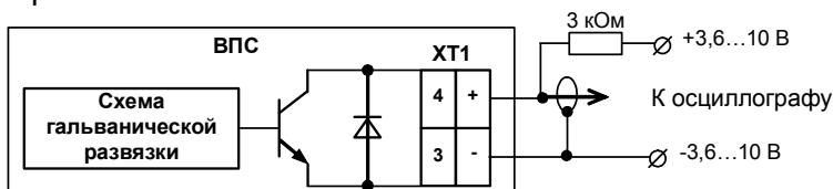
Следует помнить, что при контроле сигналов на выходах, выполненных по схеме «открытый» коллектор (OK), в случае отсутствия вторичного прибора, необходимо соединить минус дополнительного источника питания (3,6 ...10 В) с эмиттером выходного транзистора, а его коллектор - с плюсом источника питания через резистор сопротивлением не менее 3 кОм.
