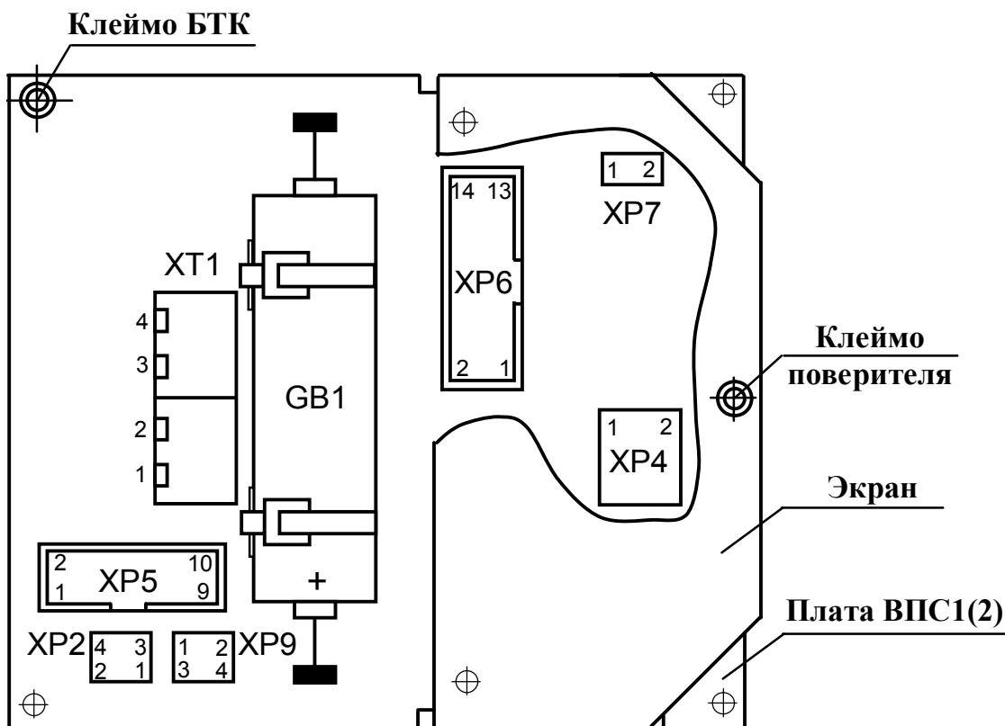
**Рисунок Б.3 – Расположение элементов управления и коммутации на плате ВПС1(2) преобразователей ВПС1(2)-ЧИ2.34,54**
